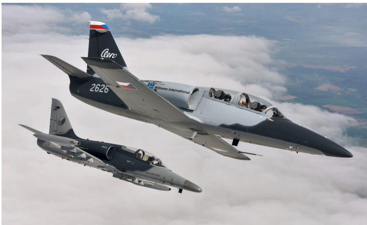
Obr. 4 – Podzvukový cvičný letoun Aero L-39 Albatros a víceúčelový lehký bojový letoun Aero L-159 Alca – vstupní ústrojí s řezači mezní vrstvy na bocích trupu (Y-tvar) (4)
