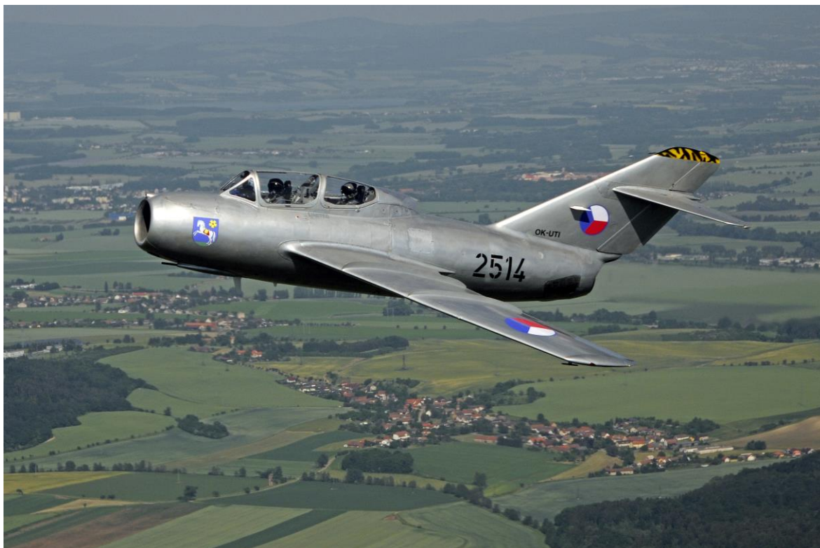
Obr. 2 – Proudový stíhací letoun MiG-15 – vstupní ústrojí čelní umístěné přímo v trupu (2)
