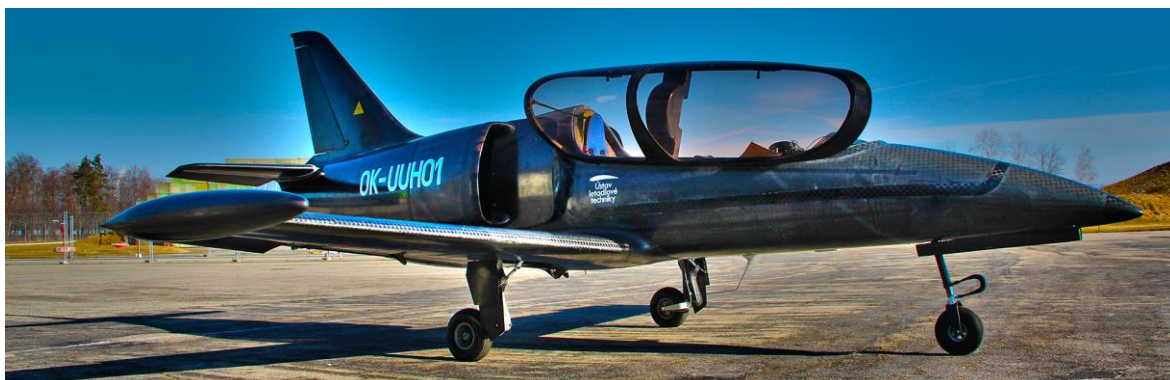
Obr. 1 – Experimentální ultralehký letoun UL-39 Albi s nekonvenčním dmychadlovým pohonem – vstupní ústrojí s řezači mezní vrstvy na bocích trupu (Y-tvar) (1)
