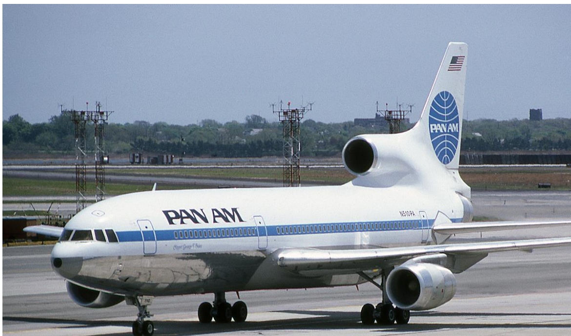
Obr. 5 – Letoun Lockheed L-1011 Tristar letecké společnosti Pan Am – vstupní ústrojí motorů na křídlech kruhové krátké s přímou střednicí, vstupní ústrojí motoru v zadní části kruhové dlouhé se zakřivenou střednicí (S-tvar) (5)
