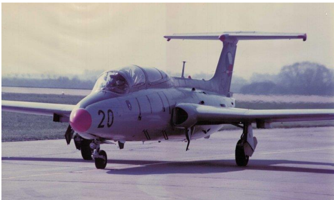
Obr. 3 – Vojenský proudový podzvukový cvičný letoun Aero L-29 Delfín – vstupní ústrojí v kořenech křídel (3)
