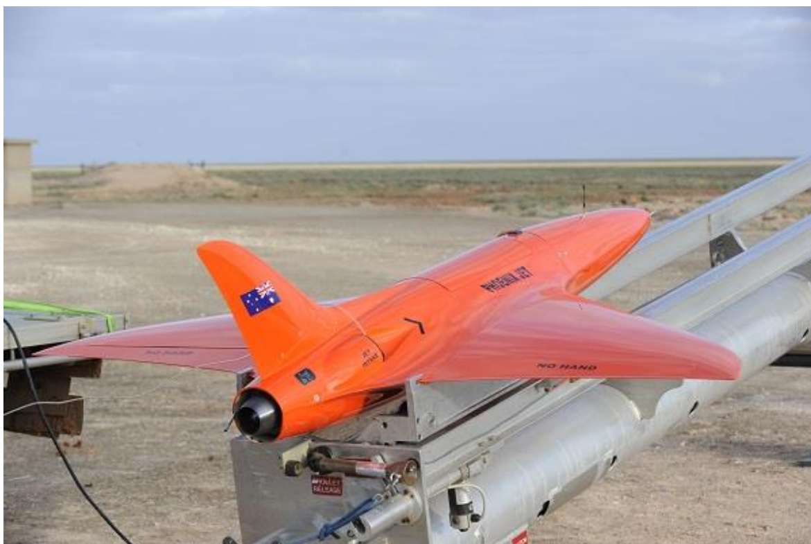
Obr. 7 – Podzvukový cvičný cíl Phoenix připravený ke stratu z katapultu – vstupní ústrojí v zadní části trupu na bocích (NACA vstup) (6)
