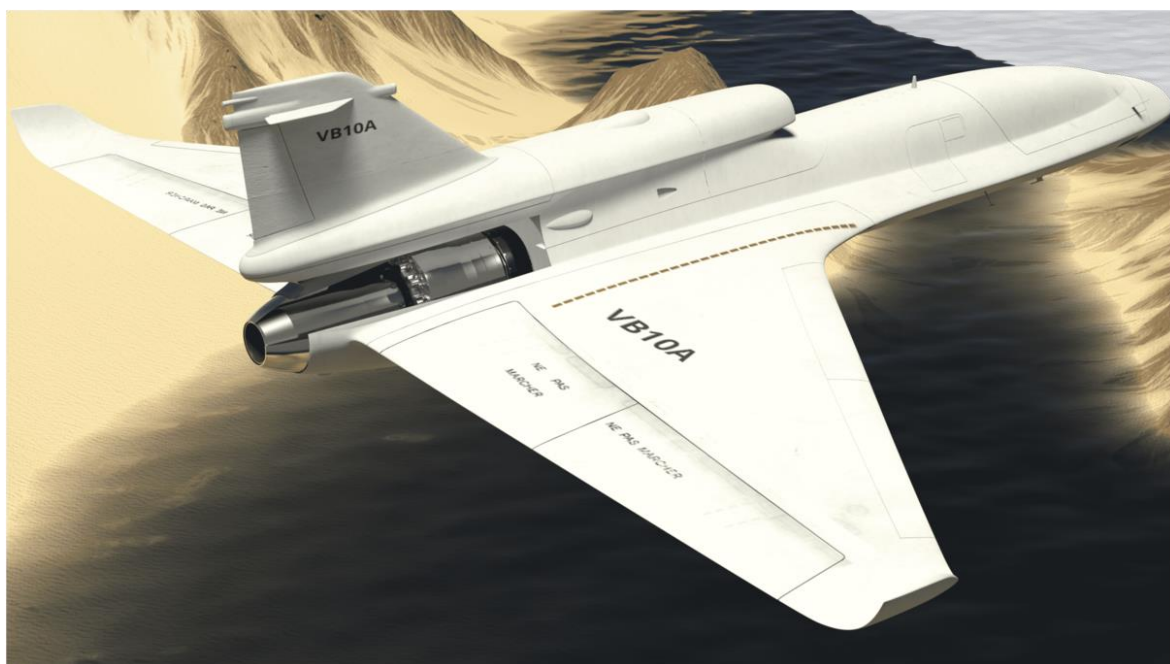
Obr. 6 – Vizualizace bezpilotního létajícího prostředku poháněného proudovým motorem české výroby PBS TJ100 – vstupní ústrojí na horní straně trupu (S-tvar) (4)
