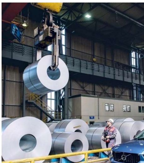
Obrázek 2 Jeřabování pomoci dálkového ovládní
