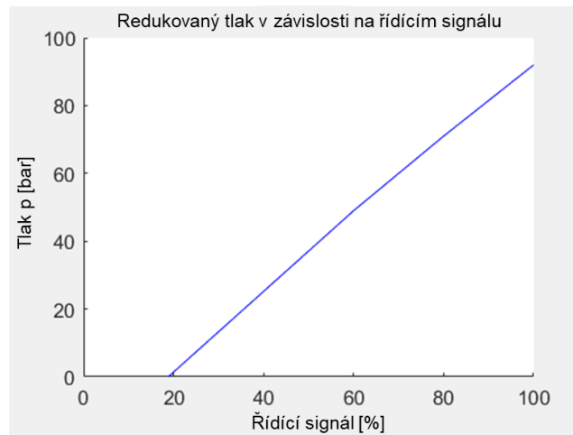
Graf 4 - Závislost redukovaného tlaku v závislosti na řídicím signálu
