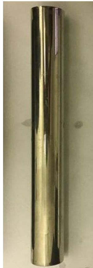
Obr. 22 Tyčový vzorek z duralu pro 0° cone test
