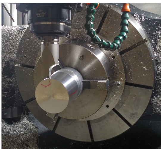
Obr. 39: Vlevo – soustružení s naklápěním osy A; vpravo – transformované dráhy nástroje ze soustružení s naklápěním osy A s žádanou dráhou nástroje
