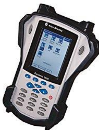
Obrázek 3.15 - Rockwell Automation Dynamix 2500 [15]
