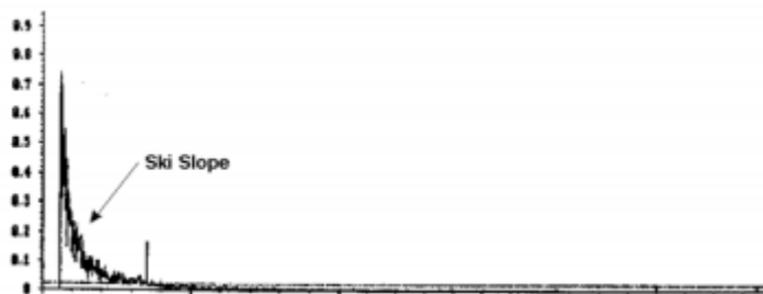
Obrázek 4.17 - Ski-slope, bývá několikrát větší než otáčková frekvenční složka [21]
