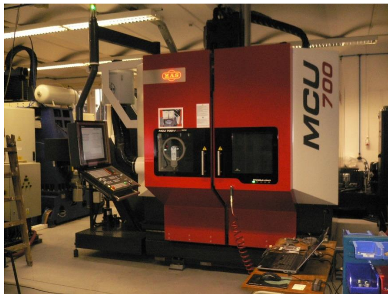
Obrázek 4.1 - Obráběcí centrum MCU 700VT-5X v prostorách Ústavu výrobních strojů a zařízení
