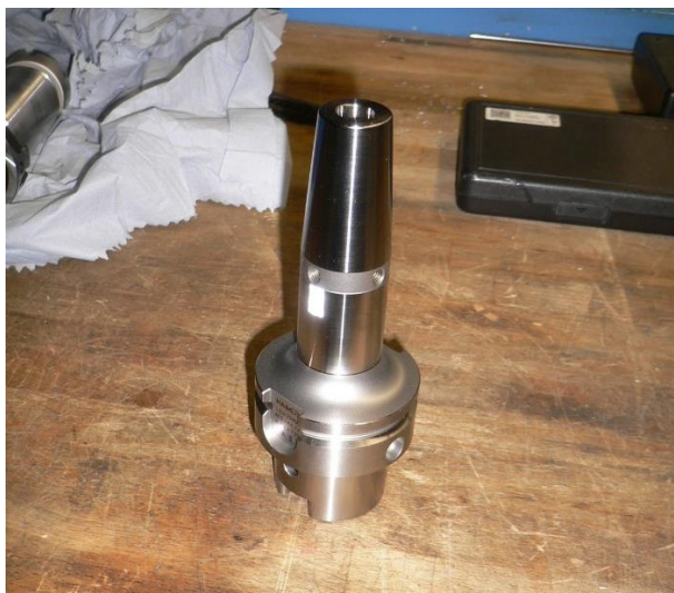
Obrázek 4.4 - Nástrojový držák HAIMER A63.144.12
