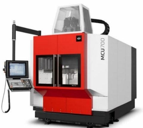
Obrázek 1.1 - Obráběcí centrum MCU 700VT-5X - výrobce KOVOSVIT MAS [20]
