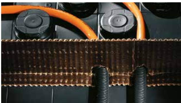
4b. Deska přívodu s dilatačním pásem 1 m
