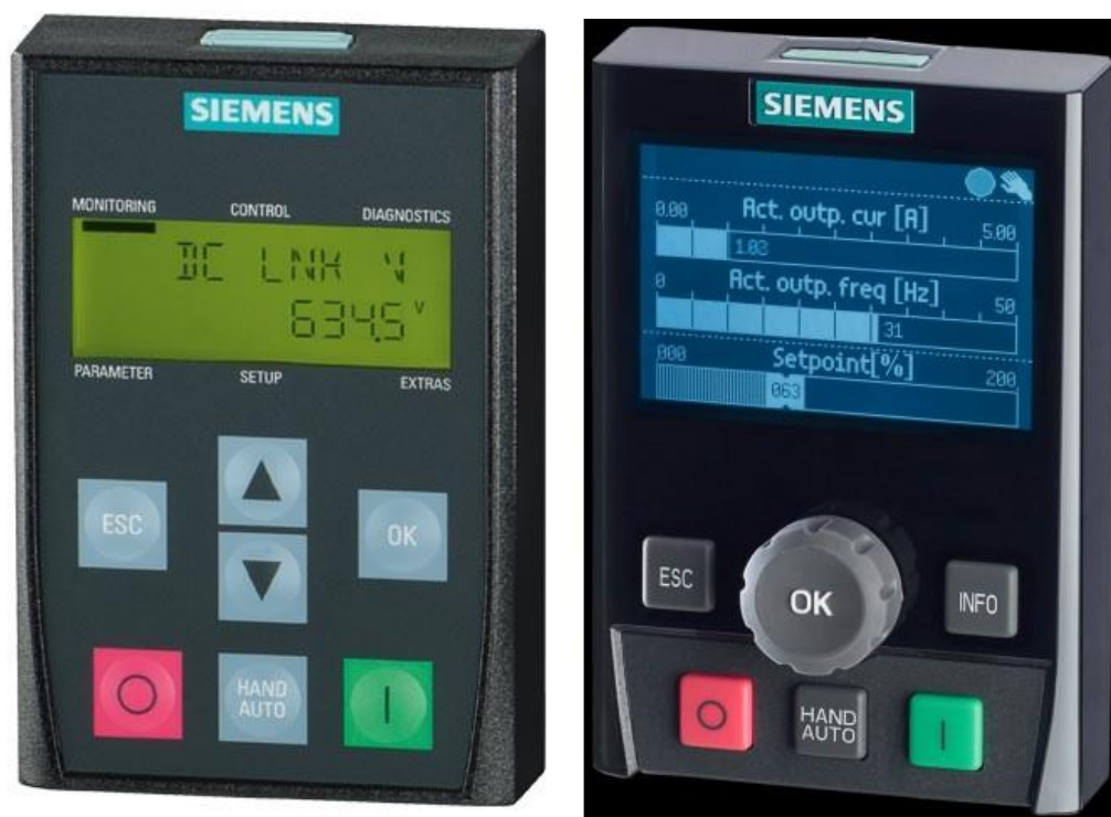
Obrázek 15 - Porovnání operátorských panelů měniče G120C [13]
