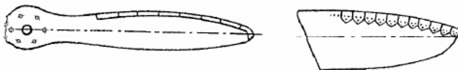
Obr. 17: Ochrana náběžné hrany dřevěného listu, převzato z: [11]
