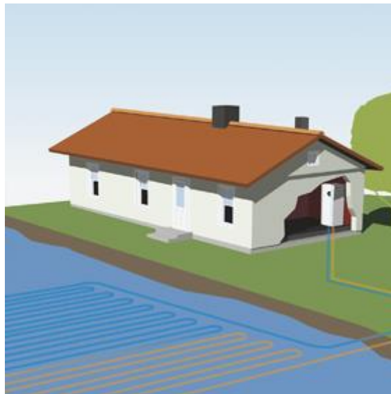
Obr. 7: Odběr tepla z povrchové vody [12]
