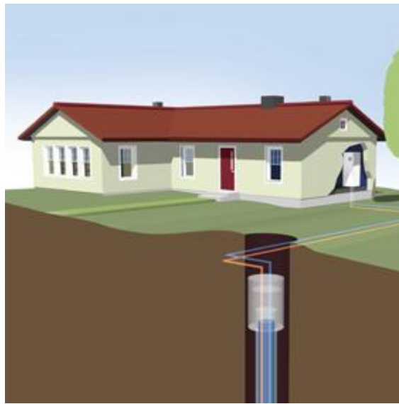
Obr. 5: Systém země/voda se svislým kolektorem [12]
