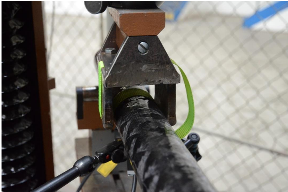
Obr. 6 Zatížení vzorku silou přes popruh
