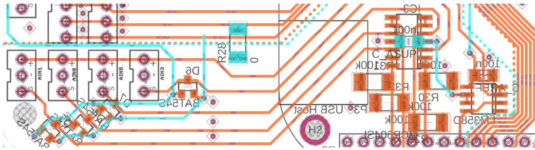
Obrázek 18: Zapojení analogových periferních obvodů na základní desce [6]
