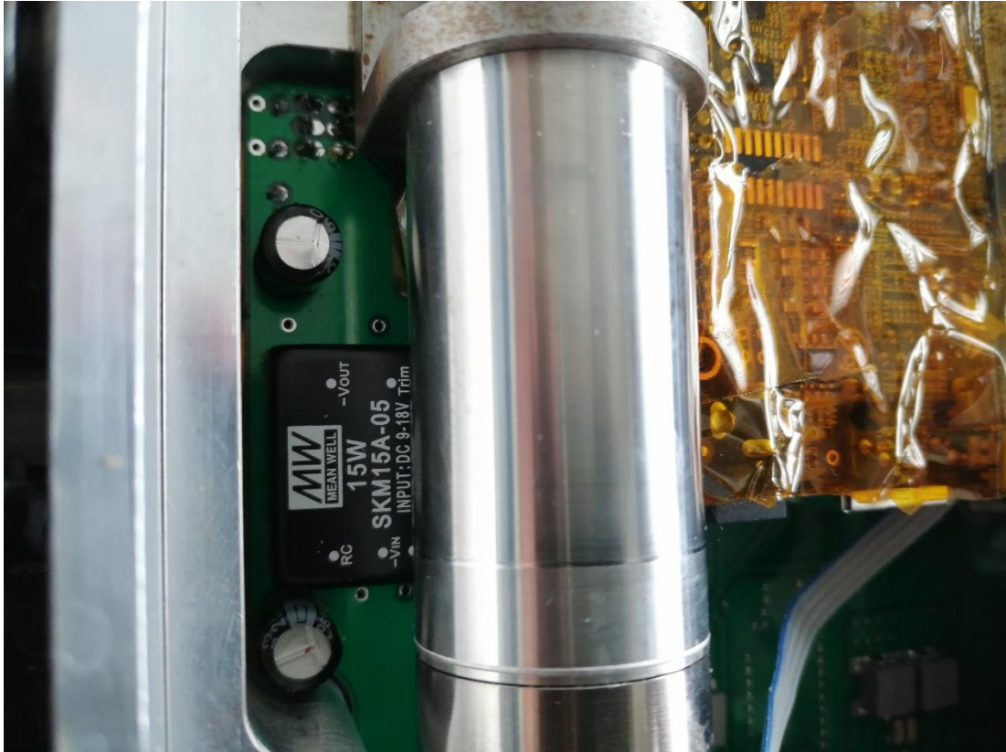
Obrázek 14: Umístění zdroje v rámci hlavní jednotky manipulátoru
