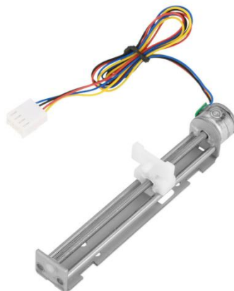
Obrázek 35 – Zvolený motor s lineární posuvovou osou [19]
