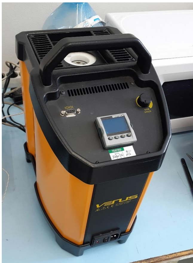
Obrázek 43: Kalibrační pec Isotech VENUS 4951 BASIC
