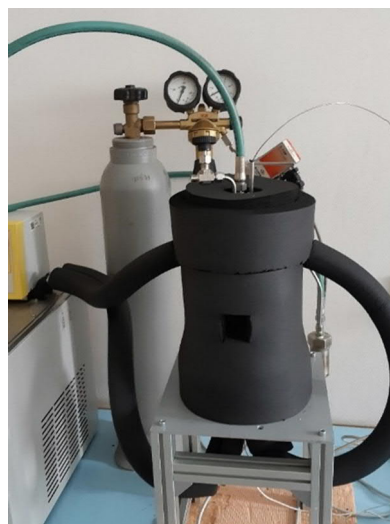
Obrázek 41: Tepelně izolovaný reaktor a hadice chladicího okruhu
