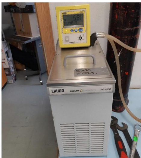
Obrázek 28: Termostat s pumpou LAUDA ECOLINE RE 206 STAREDITION
