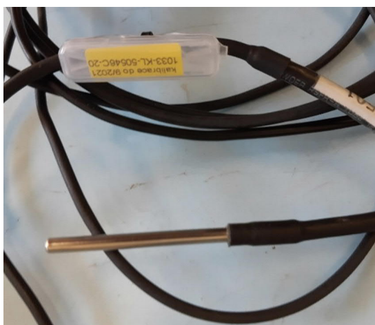
Obrázek 45: Etalonová teplotní sonda (ponorná) - odporový snímač teploty Pt100, typ HART 5606-50-P
