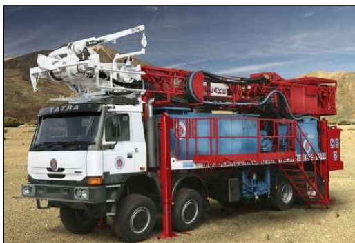
Obr. 2.2: Lehká vrtná souprava na podvozku Tatra 8x8 [5]
