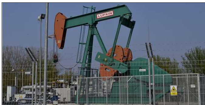
Obr. 3.4: Konvenční konstrukce kozlíku těžící na Moravě [9]
