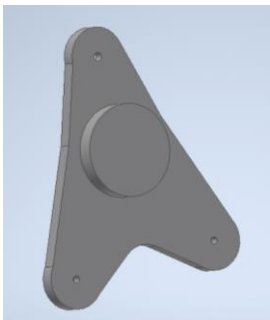
Obrázek 8-3 – Přípravek vymezující umístění pro 1/2" matici
