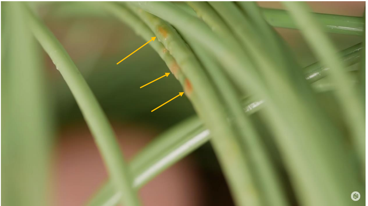
Obrázek 2-5 – Hrudky ve filamentu[4]
