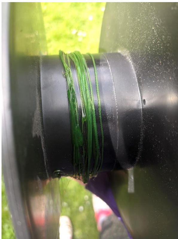
Obrázek 9-1 – Vyrobený filament navinutý na cívce
