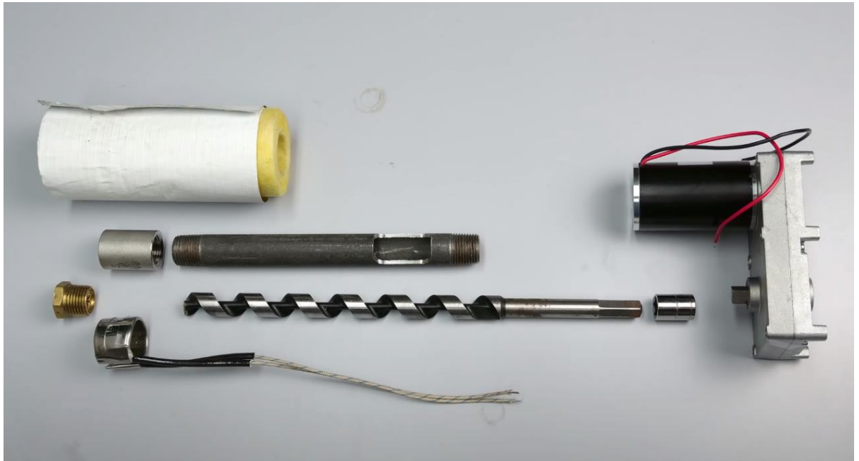
Obrázek 2-2 - Rozpad extruderu firmy Filastruder [4]
