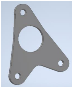
Obrázek 8-2 – Přípravek na díry pro vrtání otvorů
