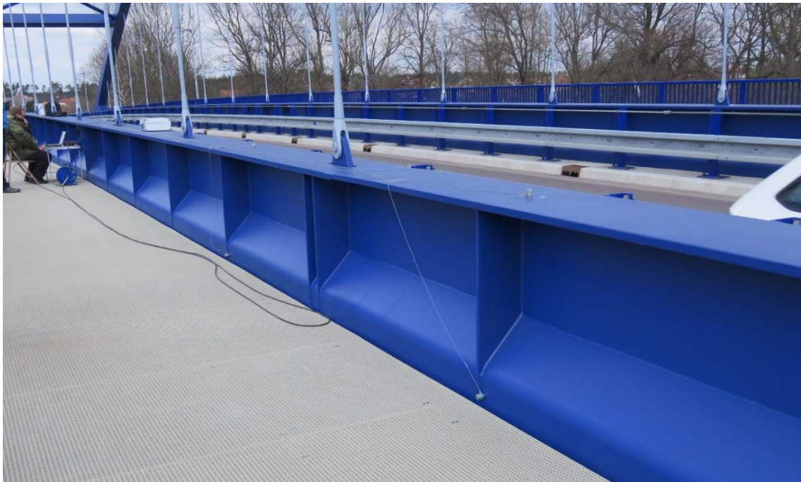
Obrázek 37: Umístění snímačů zrychlení do pětiny rozpětí (bližší snímače) a do čtvrtiny rozpětí (vzdálenější snímače) hlavního pole.
