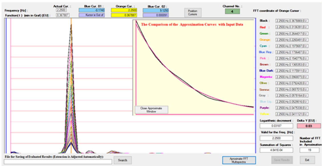
Obrázek 56: Vyhodnocení logaritického dekrementu útlumu z naměřeného záznamu. Jeho hodnota činí 0,032.
