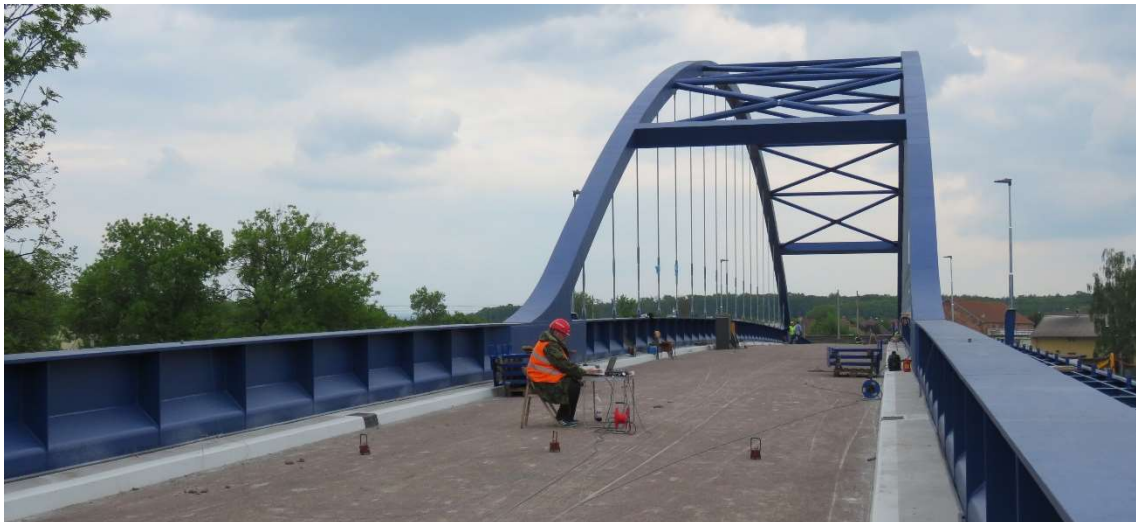
Obrázek 9: Rozmístění snímačů zrychlení po příčném řezu konstrukce.
