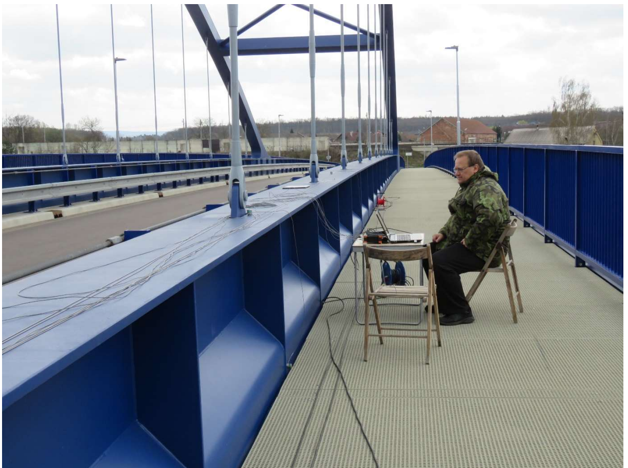
Obrázek 38: Ing. Tomáš Plachý Ph.D. ovládající měřicí ústřednu přes notebook.
