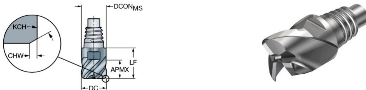
Obrázek 13: Rozměry monolitní hlavice / Fréza 316-20SM345-20000A H10F [15]
