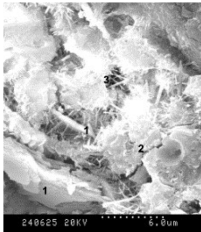
Obrázok 3: SEM fotografia cementovej pasty s 3% nano-SiO 2 . 2 – CSH. Prevzaté z [24]
