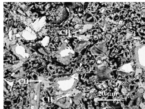
Obrázok 2: SEM-BSE snímka 7 dní starej cementovej pasty s vodným súčiniteľom 0,45, zobrazujúca detaily pórov a CH. Prevzaté z [30]
