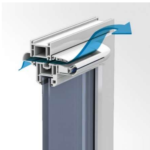
3.4 - Princip proudění vzduchu okenní štěrbinou [9]
