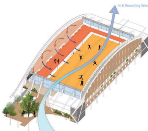
3.16 - Princip přirozeného proudění vzduchu v hale [10]
