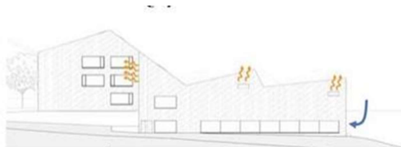
3.14 - Princip přirozeného větrání v letním období [12]
