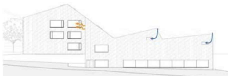
3.15 - Princip přirozeného větrání v zimním období [12]
