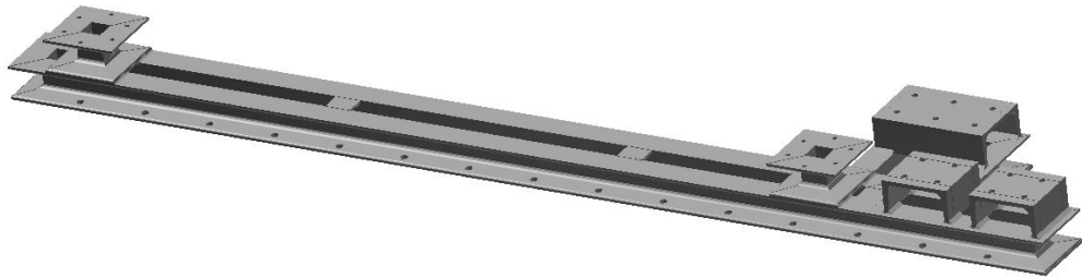
Obrázek 41 Rám větrné elektrárny
