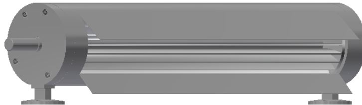
Obrázek 10 Turbína domácí větrné elektrárny
