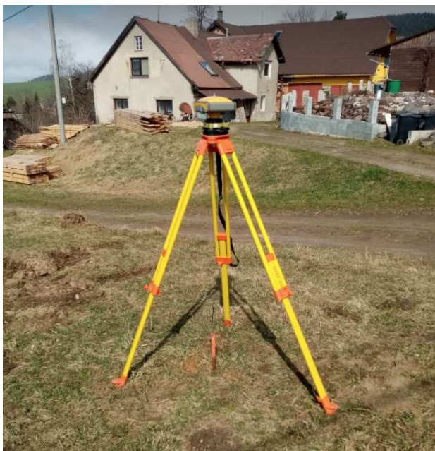
Obrázek 16: Ukázka stabilizace bodu profilu
