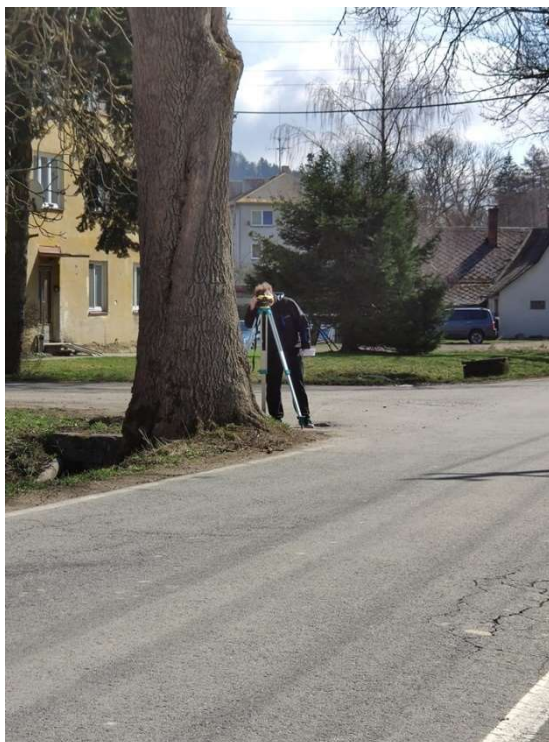
Obrázek 4: Technická nivelace v terénu
