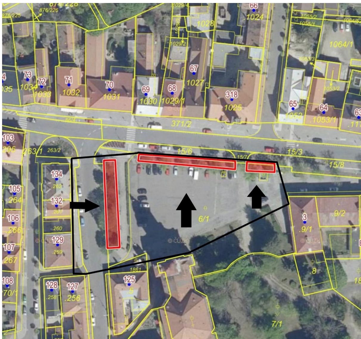
Obrázek 35: Katastrální situační výkres – Mírové náměstí [67]; červená značí obrys retenčních objektů, černě je značen obrys odpojeného území
