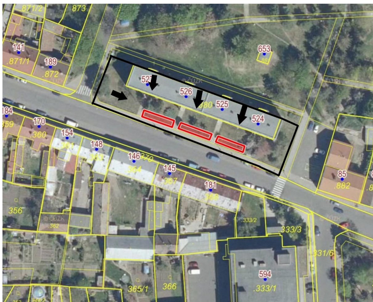
Obrázek 37: Katastrální situační výkres - Masarykova ulice [67]; červená značí obrys retenčních objektů, černě je značen obrys odpojeného území
