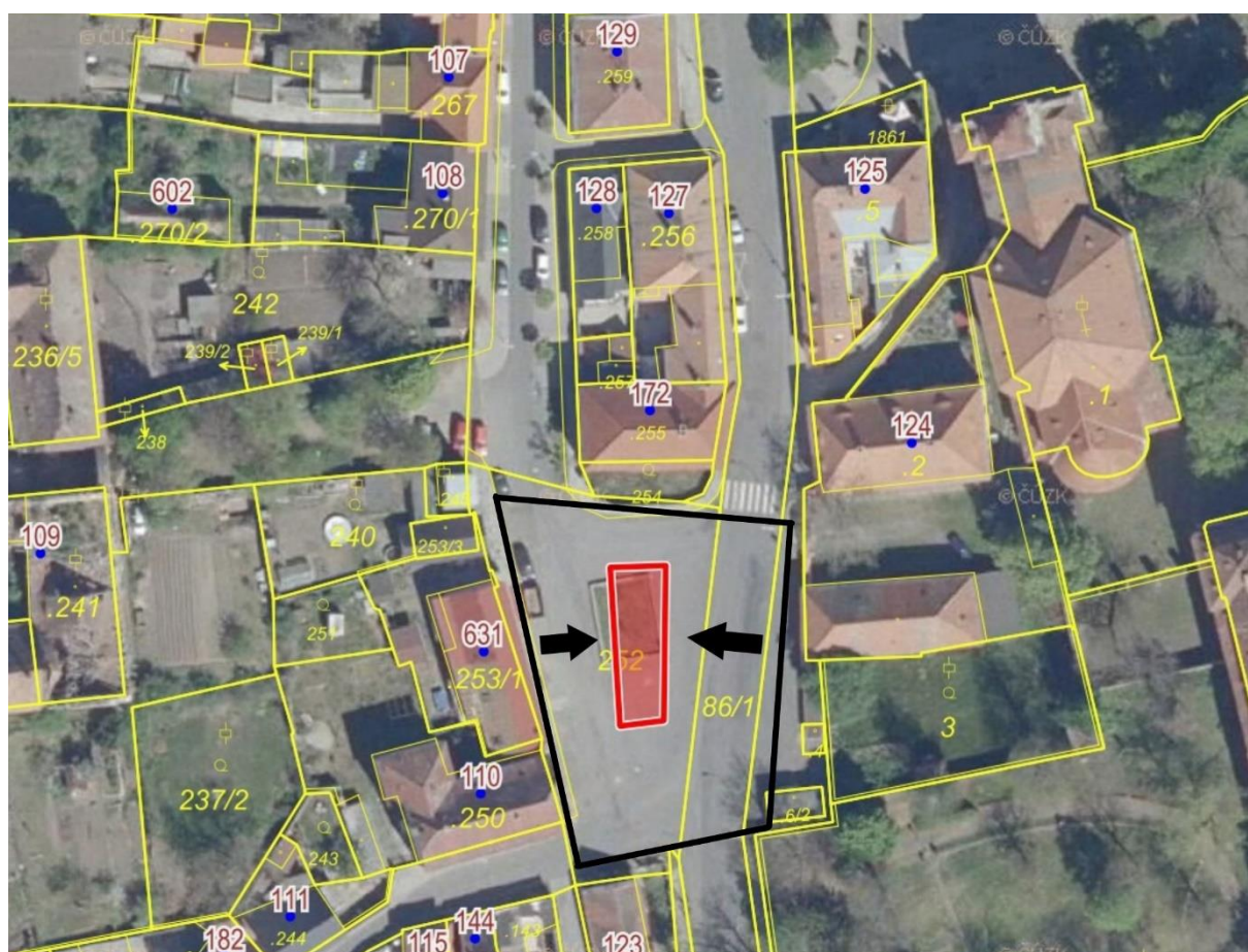
Obrázek 36: Katastrální situační výkres - Husova a 5. května [67]; červená značí obrys retenčních objektů, černě je značen obrys odpojeného území
