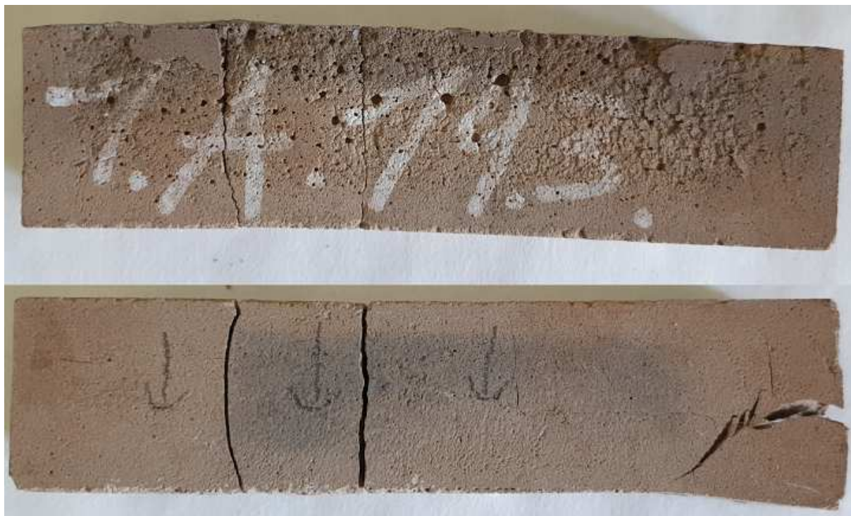
Obrázek 22 - Vzorky kaší, trámek, ohyb za zvýšené teploty, 1A, popílek
