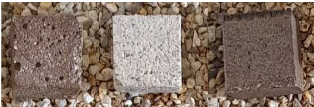
Obrázek 13 - Vzorky malt, kostky výpal 1200°C, zleva 4A,4B,4C
