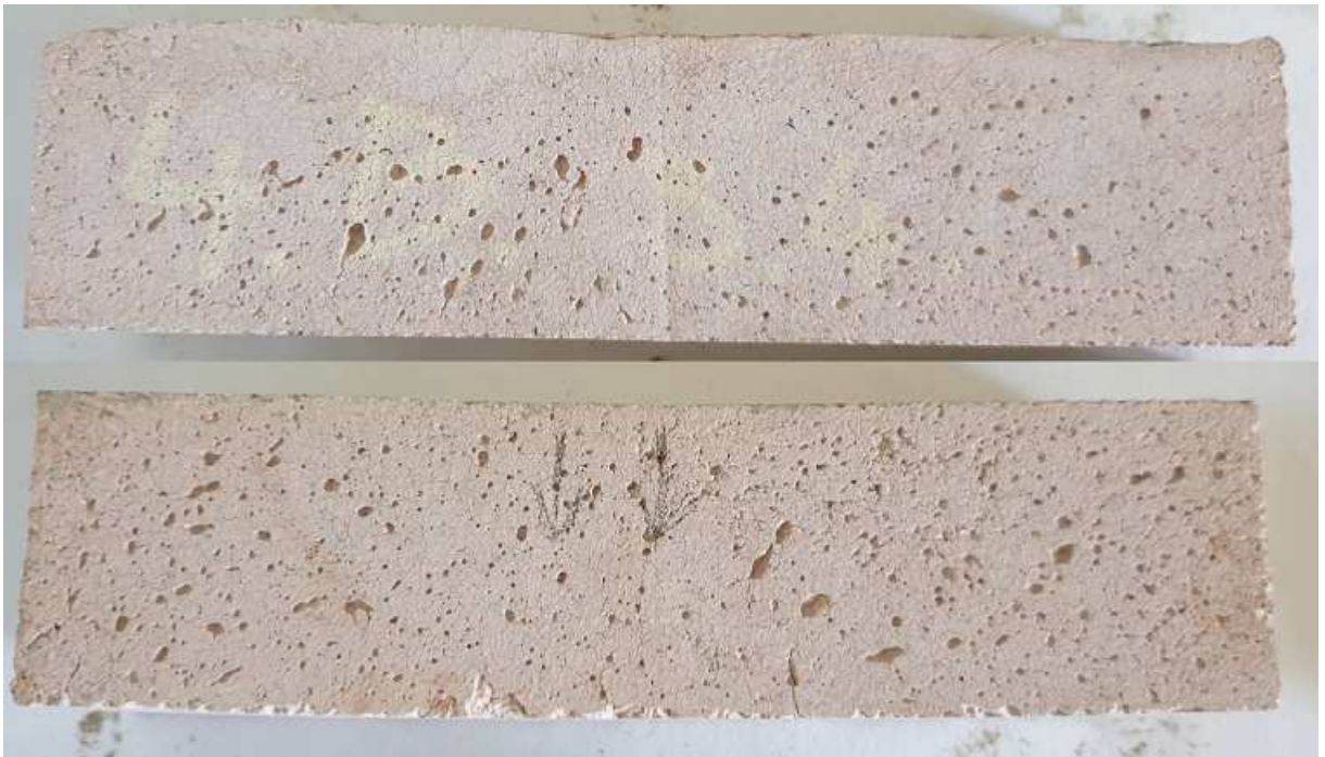
Obrázek 27 - Vzorky malt, trámek, ohyb za zvýšené teploty, 4B, metakaolin
