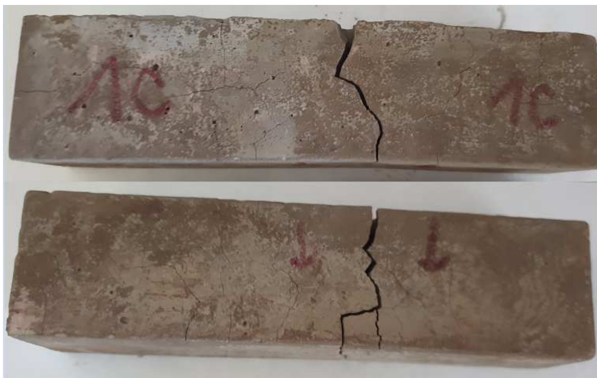
Obrázek 25 - Vzorky kaší, trámek, ohyb za zvýšené teploty, 1C, cement
