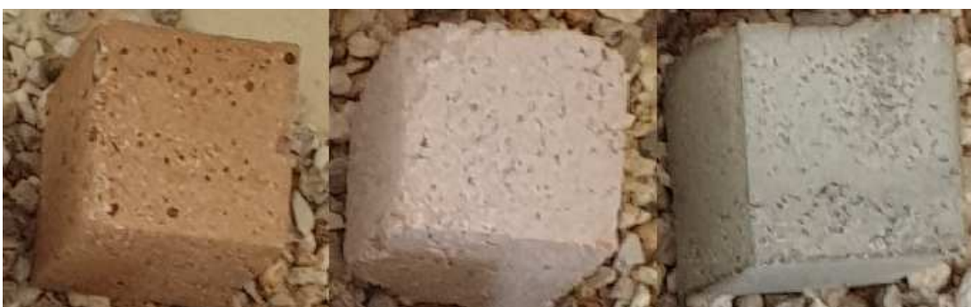
Obrázek 8 - Vzorky malt, kostky výpal 900°C, zleva 4A,4B,4C
