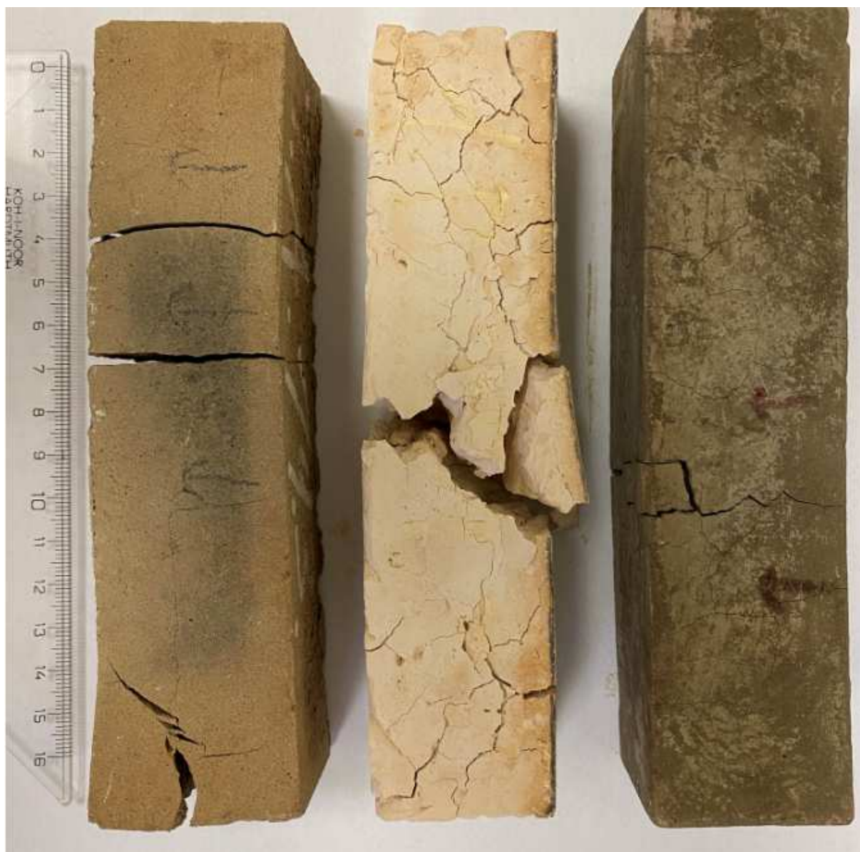
Obrázek 29 - Vzorky kaší, trámek, ohyb za zvýšené teploty, zleva 1A,1B,1C
