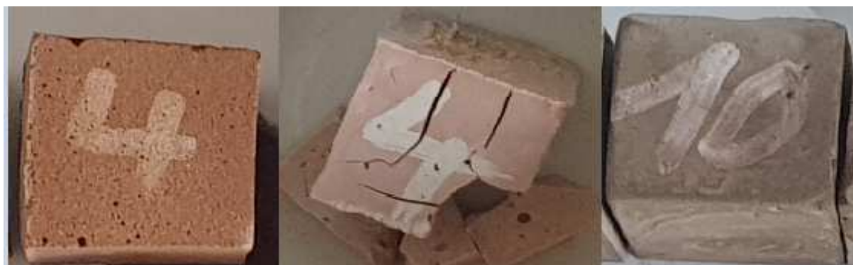
Obrázek 6 - Vzorky kaší, kostky výpal 900°C zleva 1A,1B,1C
