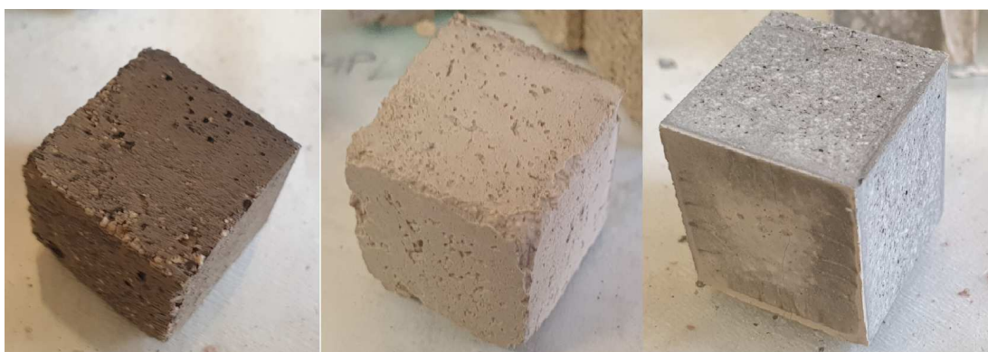
Obrázek 3 - Vzorky malt, kostky zleva 4A,4B,4C
