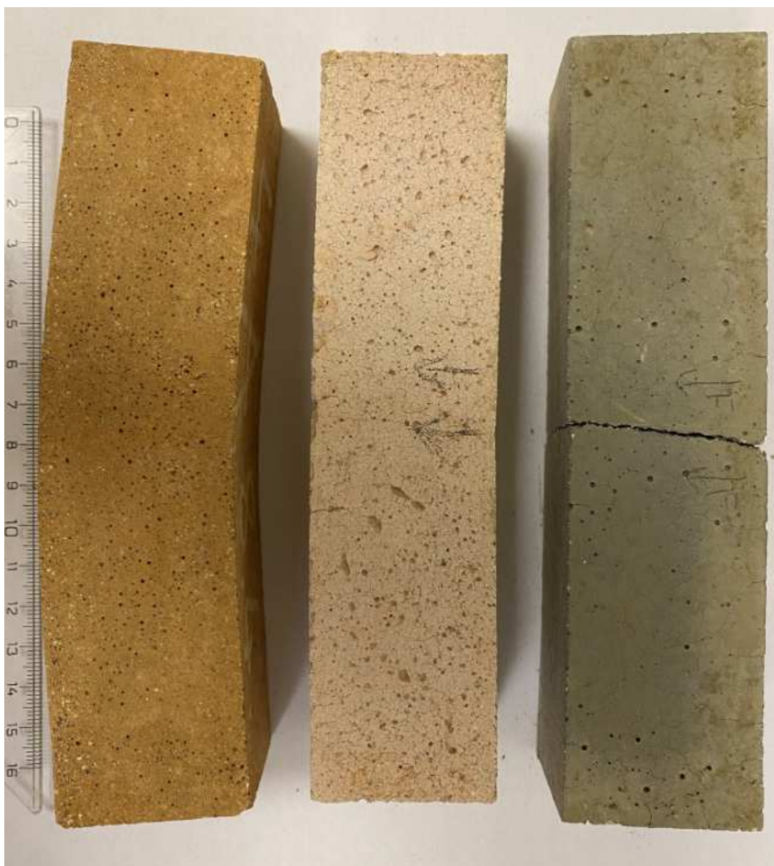
Obrázek 31Vzorky malt, trámek, ohyb za zvýšené teploty, zleva 4A,4B,4C
