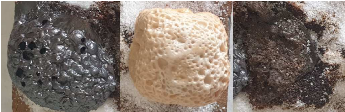
Obrázek 16- Vzorky kaší, kostky výpal 1400°C zleva 1A,1B,1C
