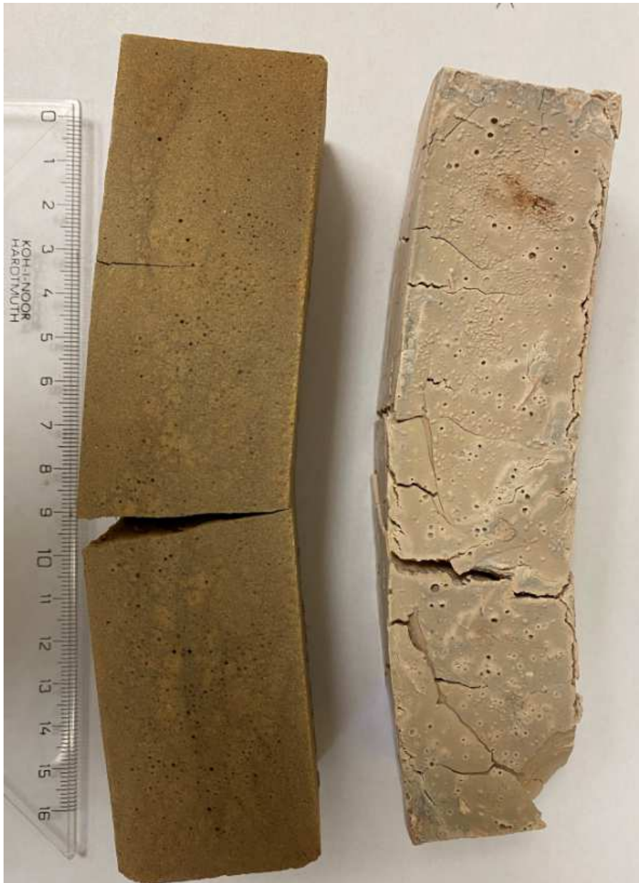
Obrázek 30- Vzorky kaší, trámek, ohyb za zvýšené teploty, zleva 1AK,1BK
