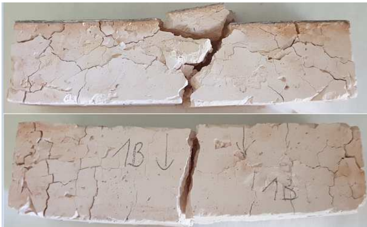
Obrázek 23 - Vzorky kaší, trámek, ohyb za zvýšené teploty, 1B, metakaolin
