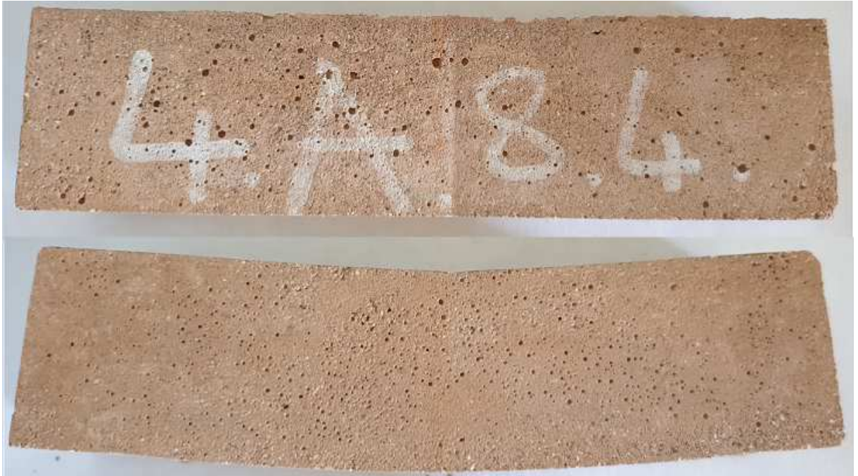
Obrázek 26 - Vzorky malt, trámek, ohyb za zvýšené teploty, 4A, popílek
