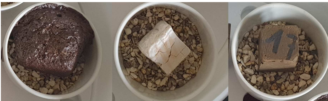
Obrázek 11 - Vzorky kaší, kostky výpal 1200°C zleva 1A,1B,1C
