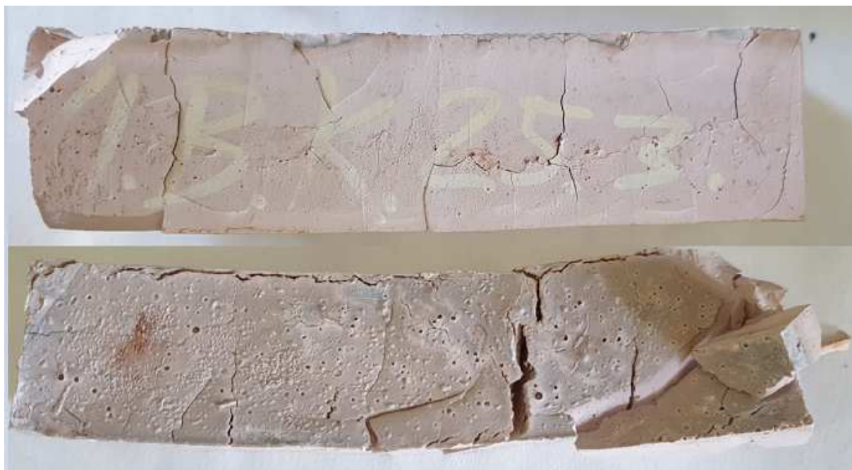
Obrázek 24 - Vzorky kaší, trámek, ohyb za zvýšené teploty, 1BK, metakaolin
