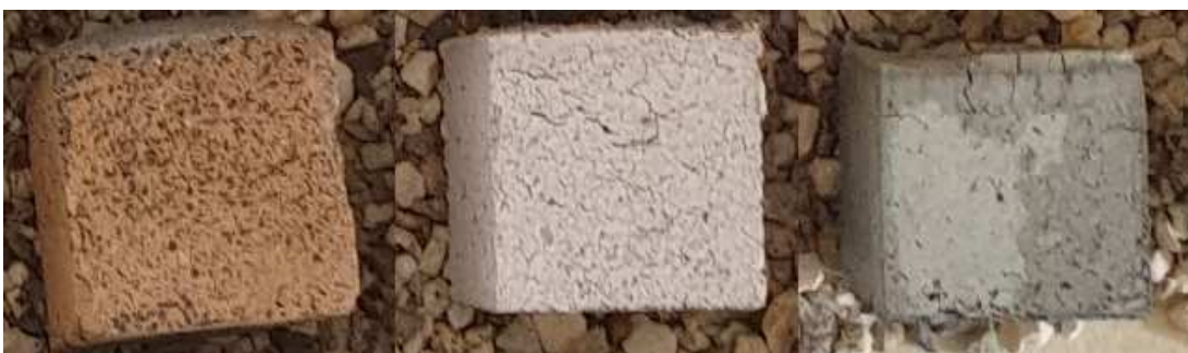
Obrázek 9 - Vzorky malt, kostky, výpal 900 °C 5A,5B,5C
