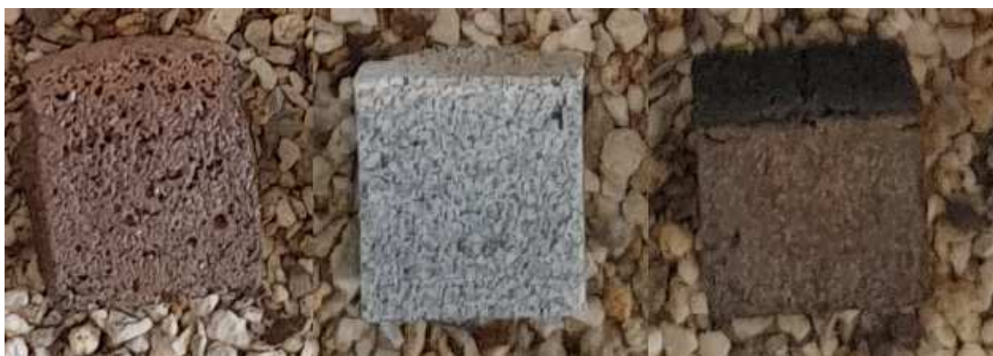
Obrázek 14 - Vzorky malt, kostky, výpal 1200 °C 5A,5B,5C
