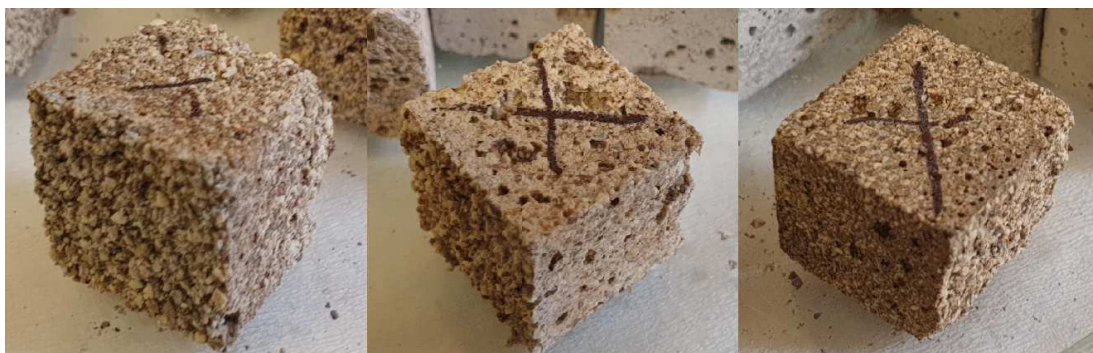
Obrázek 15- Vzorky malt, kostky, výpal 1200 °C 6A,6B,6C
