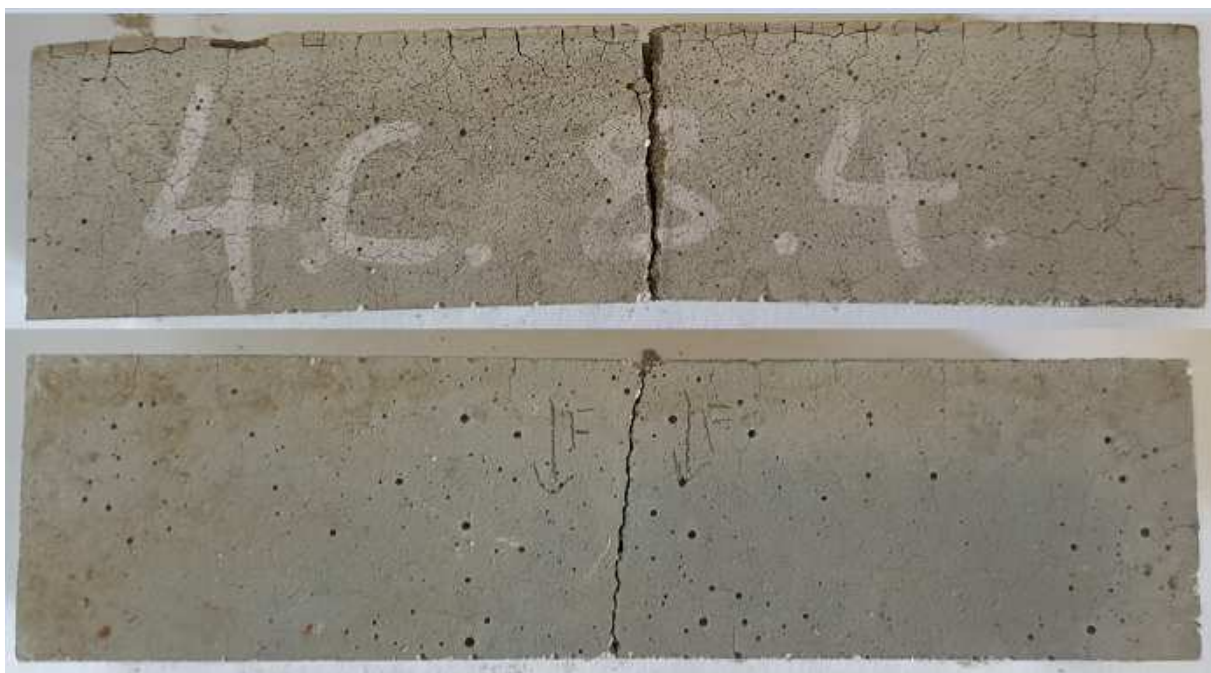
Obrázek 28 - Vzorky malt, trámek, ohyb za zvýšené teploty, 4C, cement
