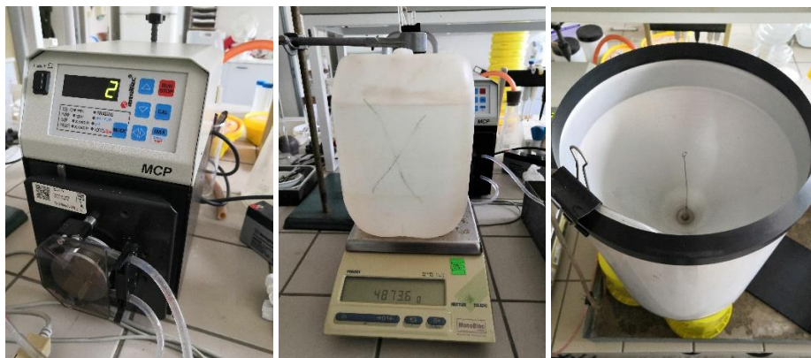
Obr. 65: Jednotlivé prvky aparatury pro dynamickou kalibraci srážkoměru: peristaltické čerpadlo (vlevo), váha s nádobou s vodou (uprostřed) a srážkoměr s ustalovacím válcem (vpravo)
