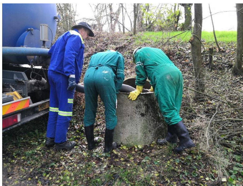
Obr. 70: Nadlepšování průtoku upouštěním vody z cisterny – poslední kontrola před spuštěním testu
