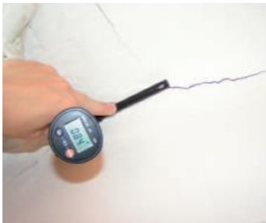
Obr.10a: proudění vzduchu skrz trhlinu omítky [1]
