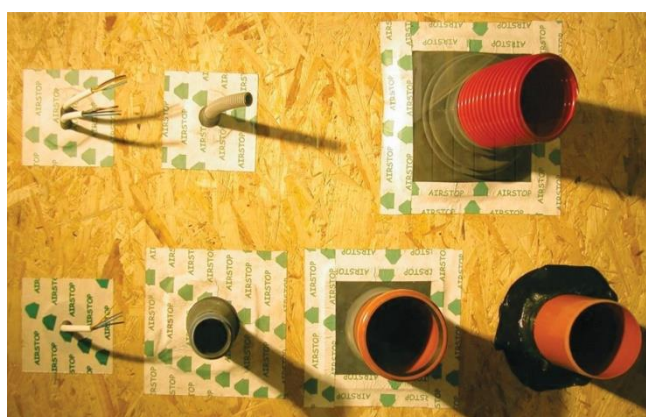
Obr.18a: různé druhy manžet pro kabely a potrubí [10]
