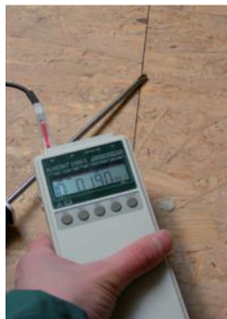
Obr.10b: proudění vzduchu skrz netěsnost ve spoji [1]
