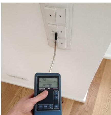
Obr.14a: proudění vzduchu skrze vypínač [1]
