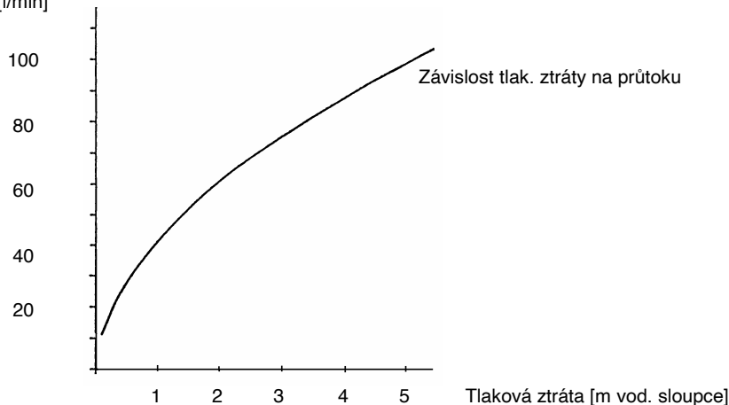
Obr. č. 18 Charakteristika trojcestného ventilu Honeywell V 4044F
