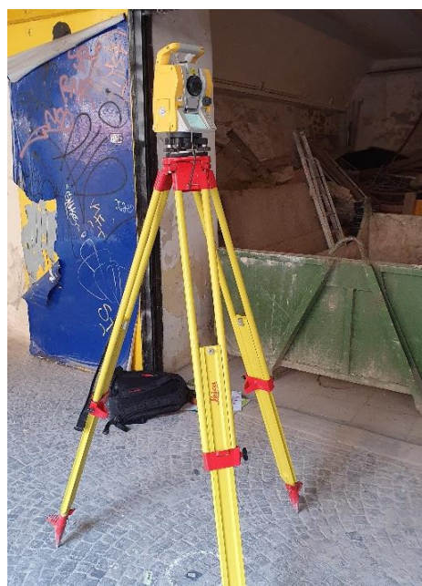
Obrázek 15 – Totální stanice Trimble M3 na stanovisku
