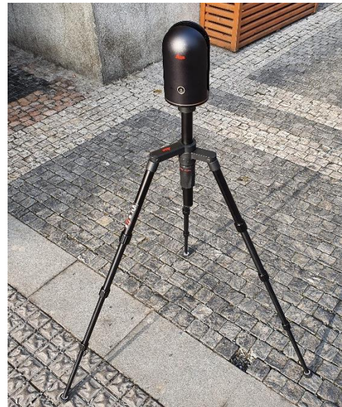
Obrázek 13 – Skener při měření na stanovisku
