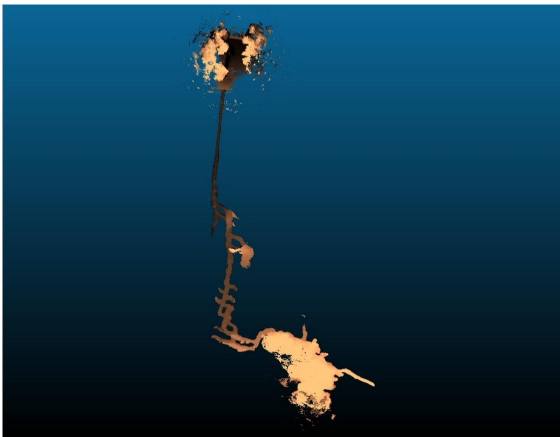
Obr. 22 - ZEB-Revo Go měření odvodňovací štolý před opravou
