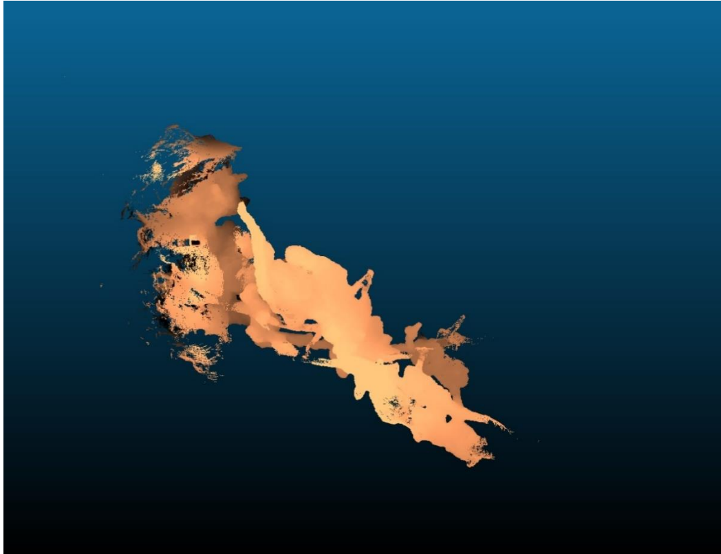
Obr. 30 - ZEB-Revo Go měření hornických chodeb
