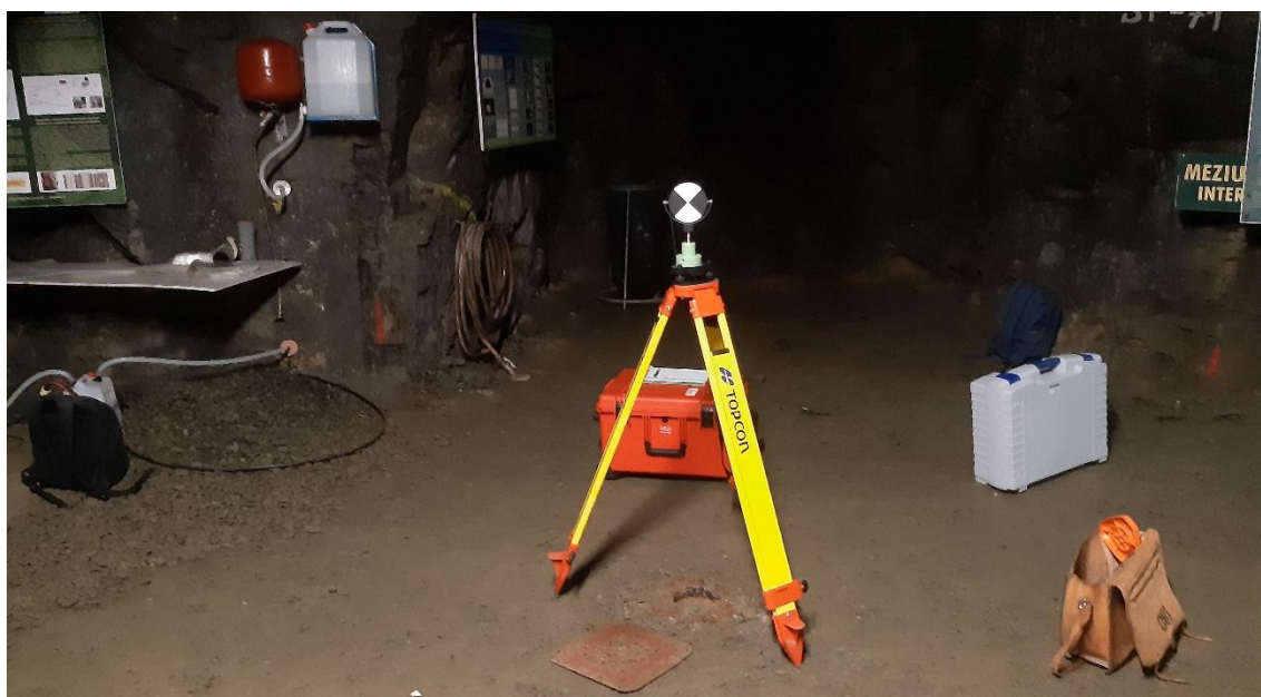
Obr. 13 Čiernobiely terč na statíve na bode 524
