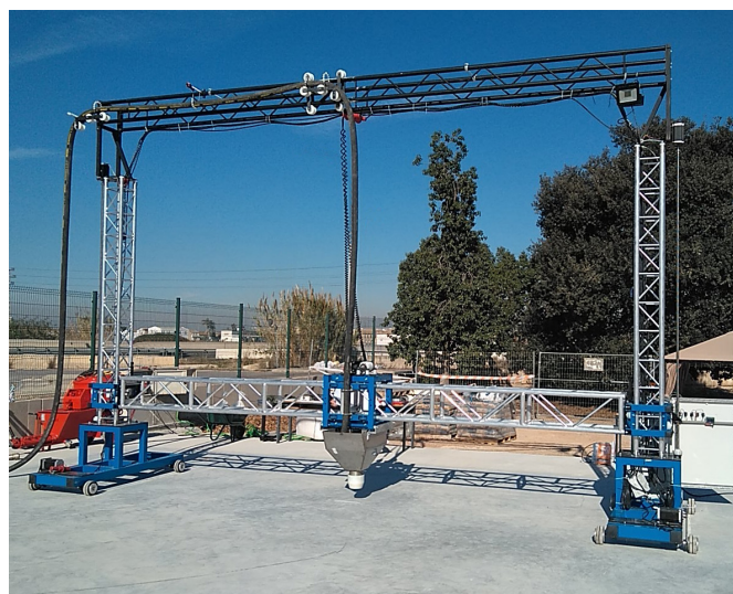
obr. 25 Tlačiareň BEM PRO pripravená na betónovej základovej doske
