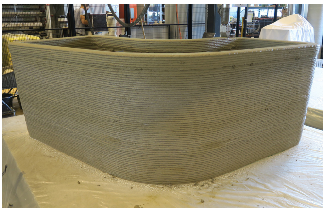
obr. 85 Vykonzolovaná časť steny bez vnútornej štruktúry
