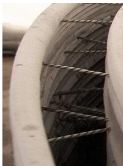
obr. 52 Tyčová výstuž zo sklenených vlákien
