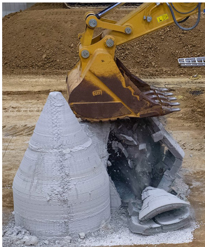
obr. 101 Model obydľia nevydržal skúšku zaťaženia v tlaku
