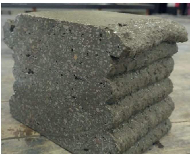
obr. 27 Medzi jednotlivými vrstvami bola vytvorená súvislá masa betónu
