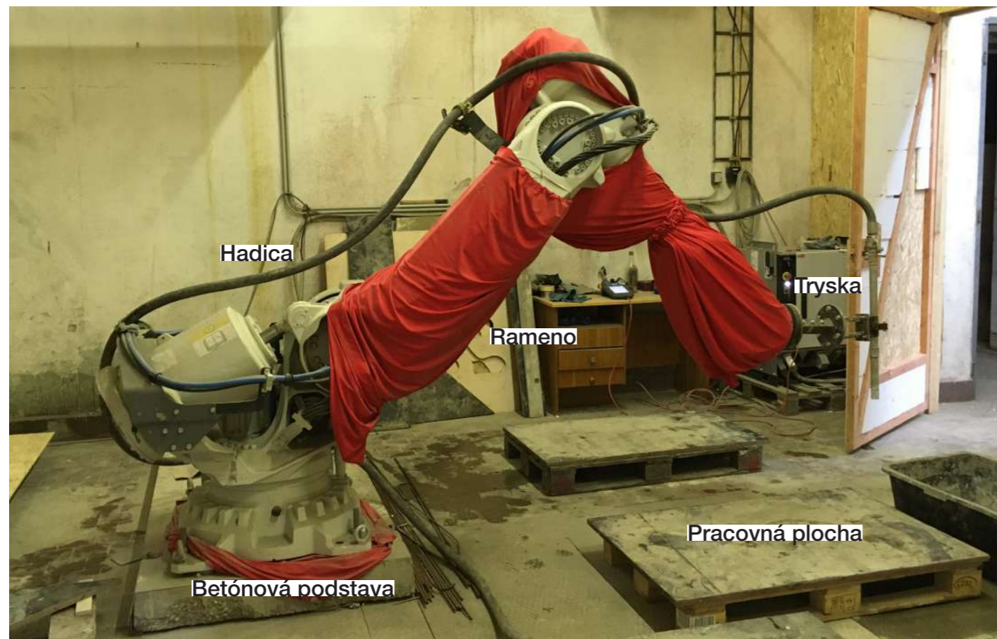
Robotické rameno ABB irb 6700 so 6 stupňami voľnosti o hmotnosti 2,5t. Rameno tlačí vrstvy široké 45-50 mm a vysoké 12 mm rýchlosťou 90-180 mm/s. Rameno je kotvené do betónovej podstavy.
