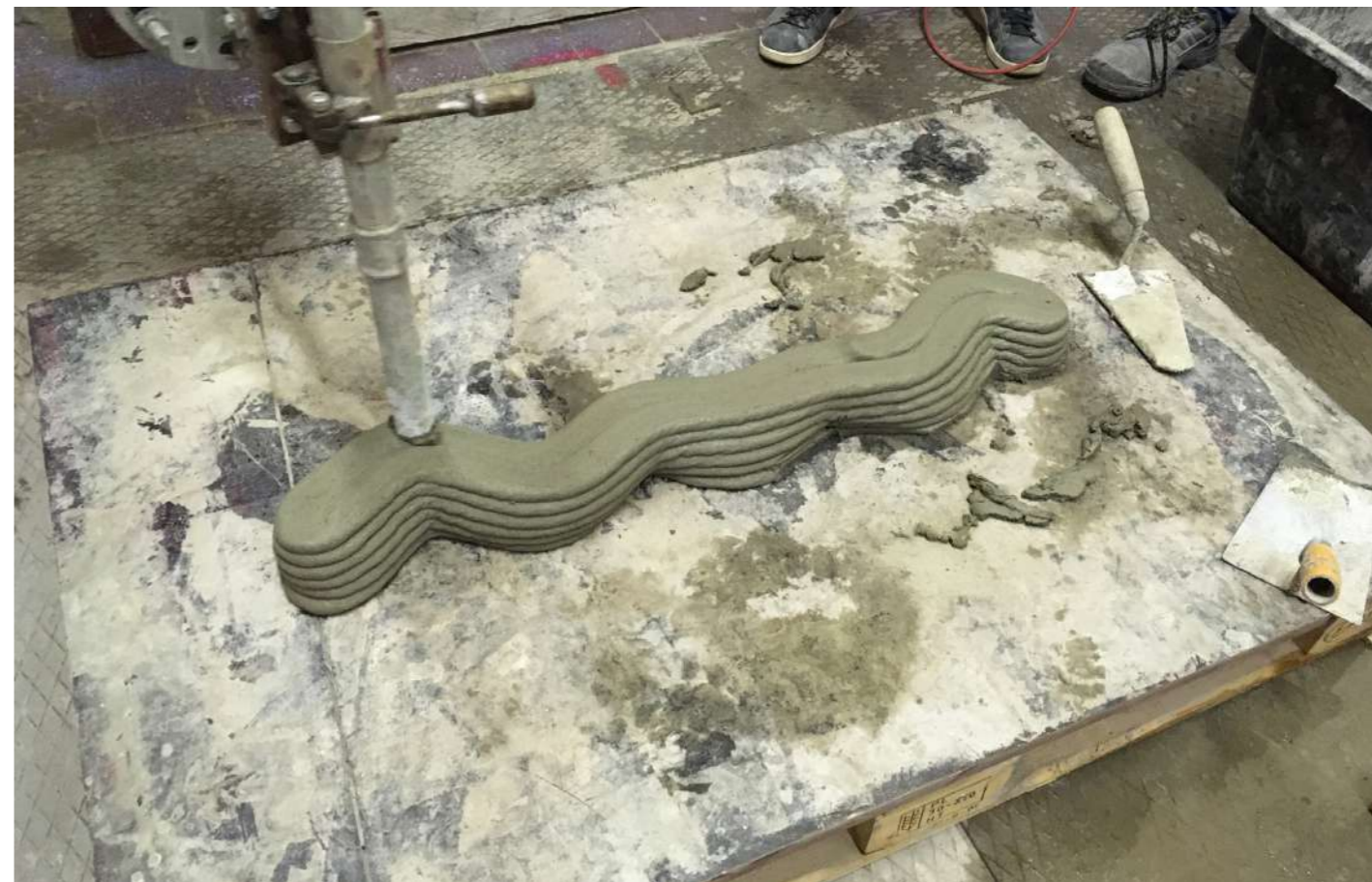
Tlač 6. vrstvy. Vrstvy sa podľa modelu začínajú vychýľovať vo vertikálnej rovine.
