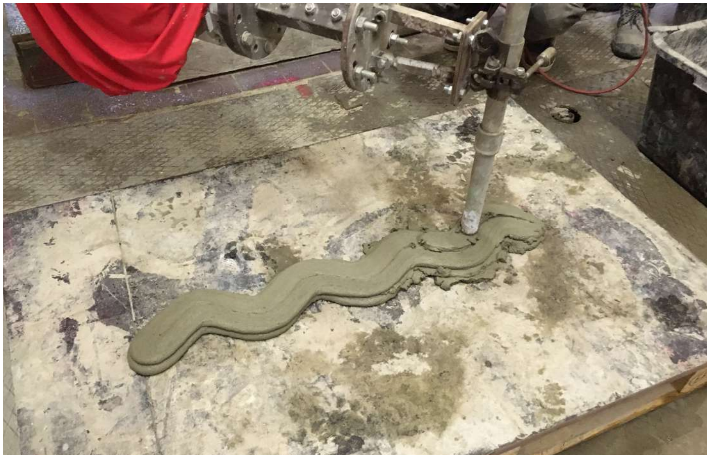
Začiatok tlače vzorky steny na pracovnej ploche - 1. a 2. vrstva steny.
