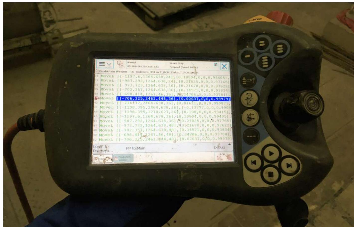
Ovládací panel robotického ramena ABB. Na displeji sú zobrazené súradnice jednotlivých krokov pohybu robota.
