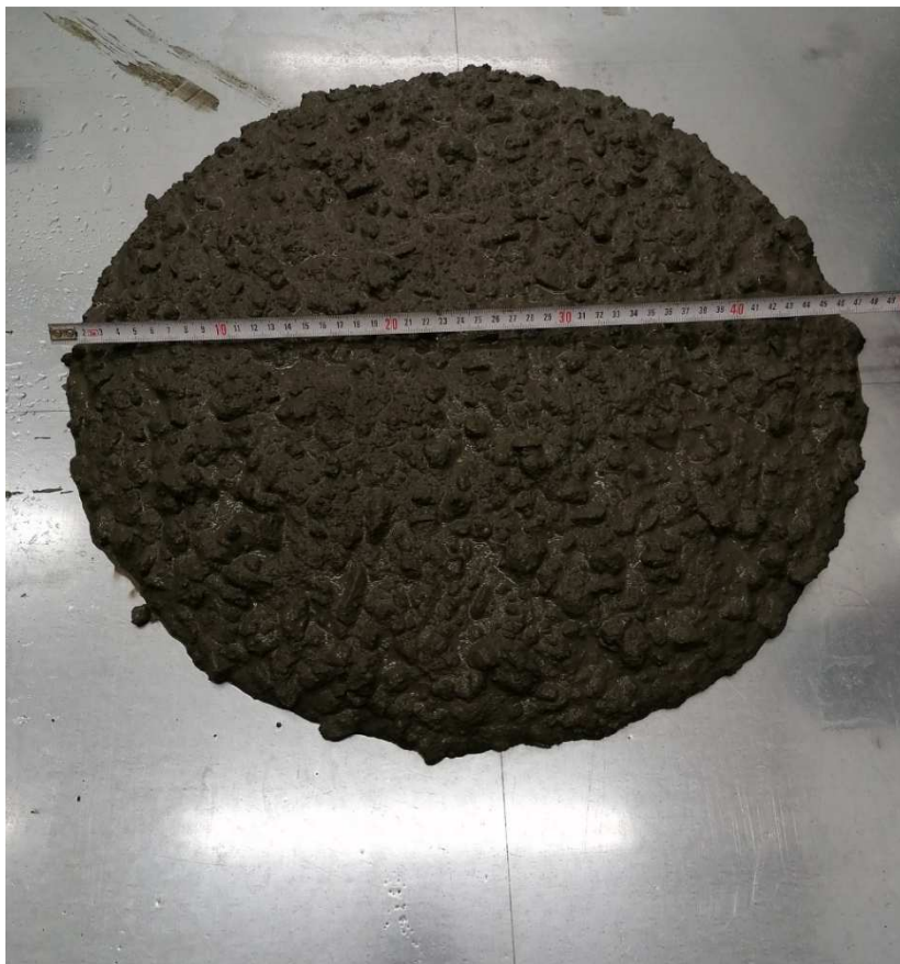
Obr. 15 – Měření konzistence čerstvého betonu metodou rozlívání
