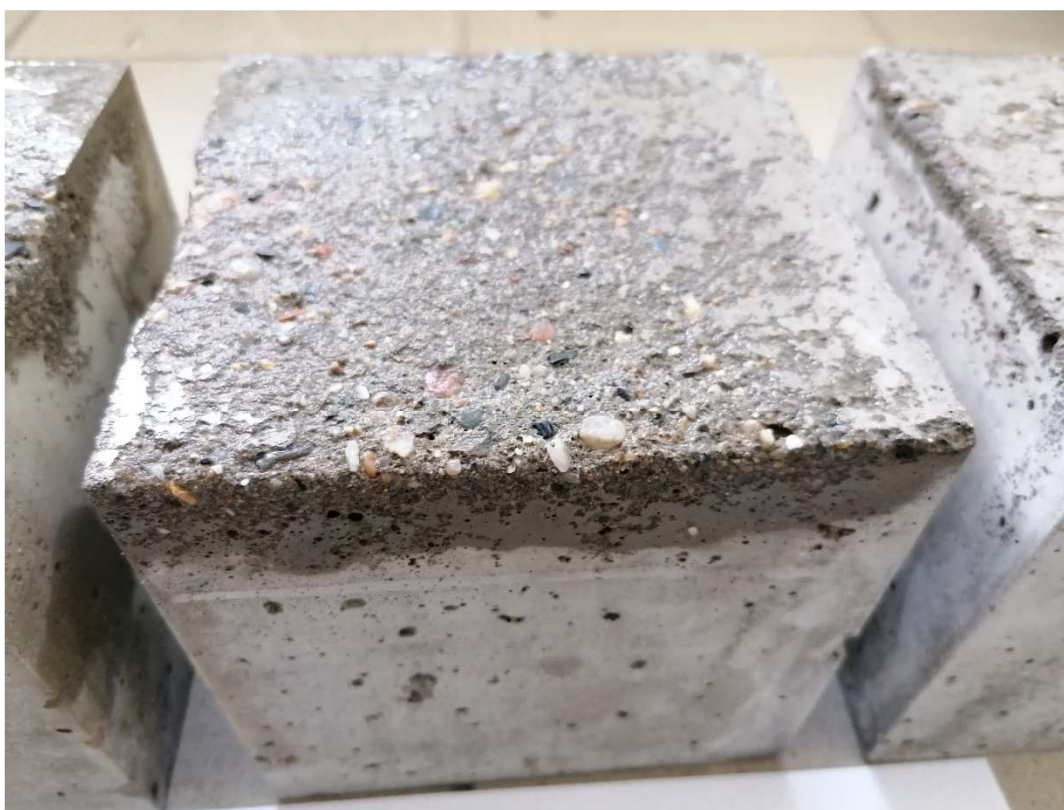
Obr. 19 – Detail porušení povrchu vzorku po zkoušce odolnosti vůči CHRL
