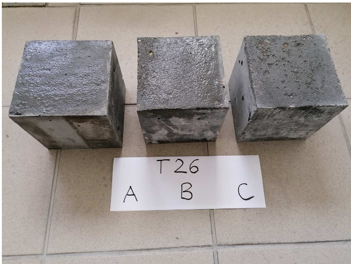
Obr. 20 – Příklad vyhovujícího výsledku zkoušky odolnosti vůči CHRL
