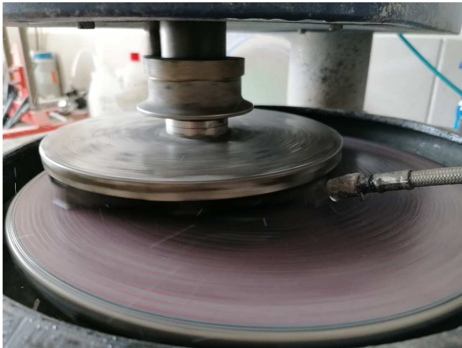
Obr. 21 – Broušení vzorku brusným kotoučem
