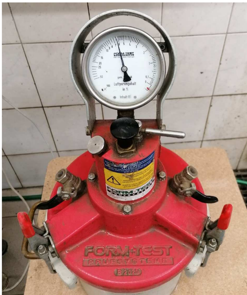
Obr. 16 – Měření obsahu vzduchu v čerstvém betonu tlakovou metodou
