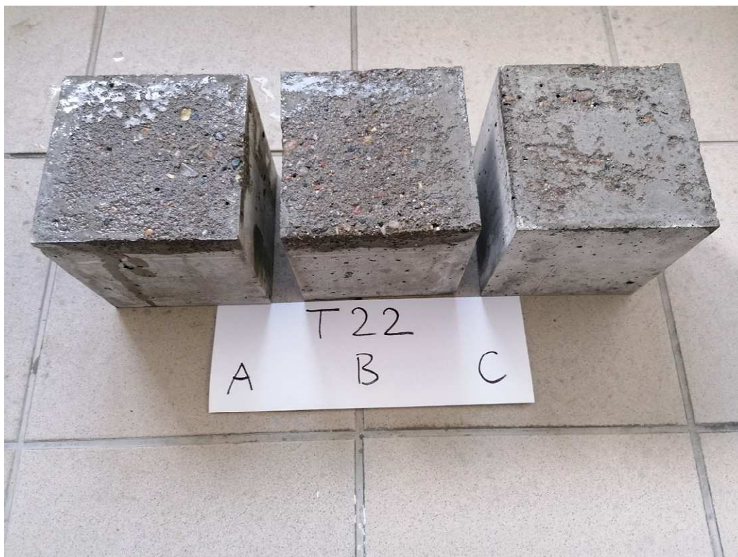
Obr. 18 – Příklad porušení povrchu vzorků po zkoušce odolnosti vůči CHRL
