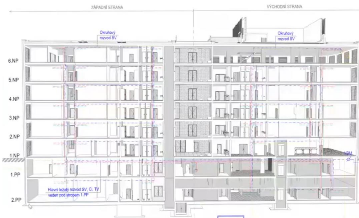
Obrázek 5-5: BIM Schéma vodovodu Biocentrum – Kampus Albertov
