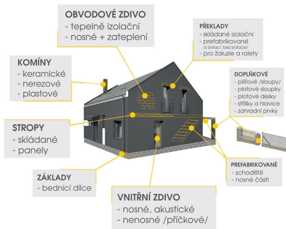
Obrázek 42 – Použití výrobků dle části stavby
