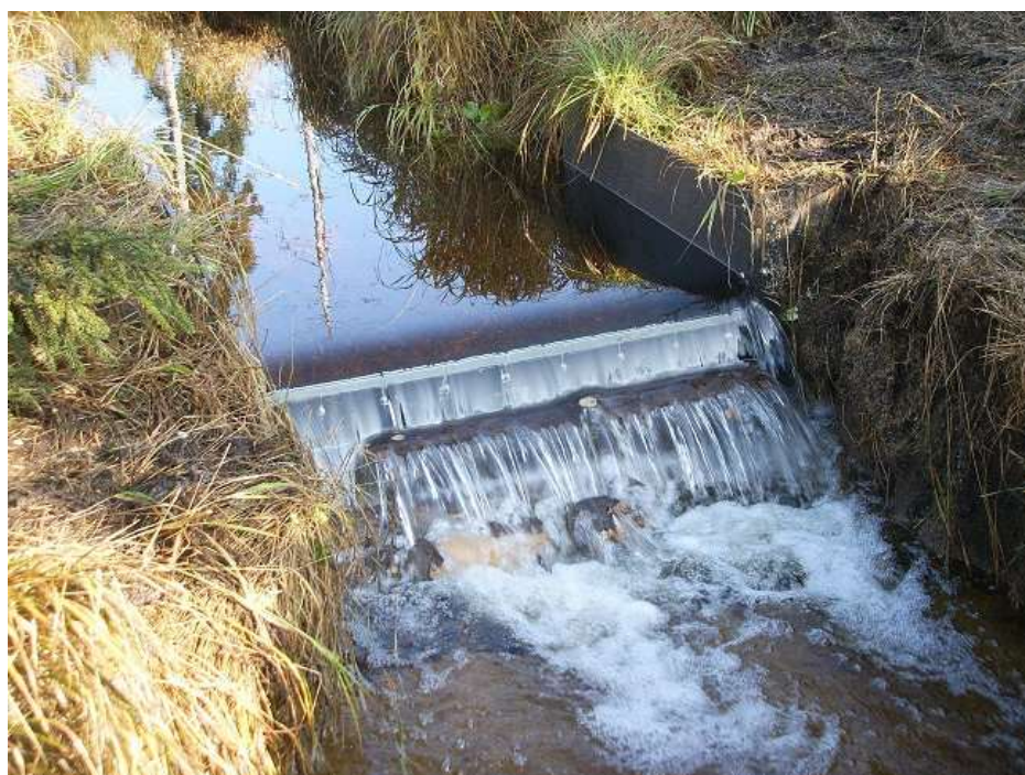
Obrázek 13 – Nainstalovaný měrný Bazinův přeliv v uzávěrovém profilu
