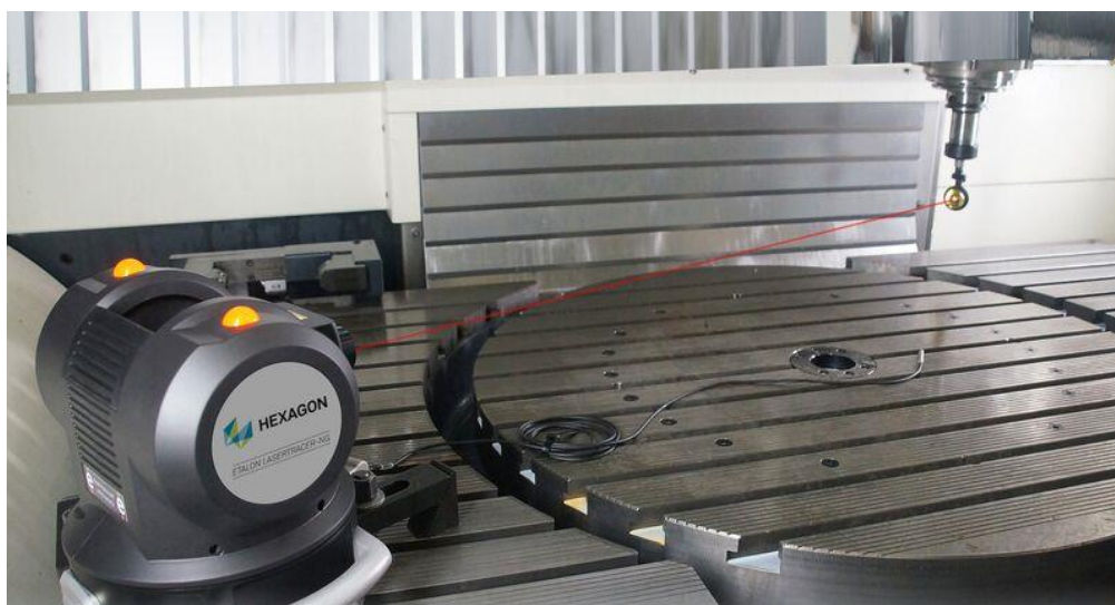
Obrázek 42 Kalibrace obráběcího stroje pomocí LASER TRACKERu[21]
