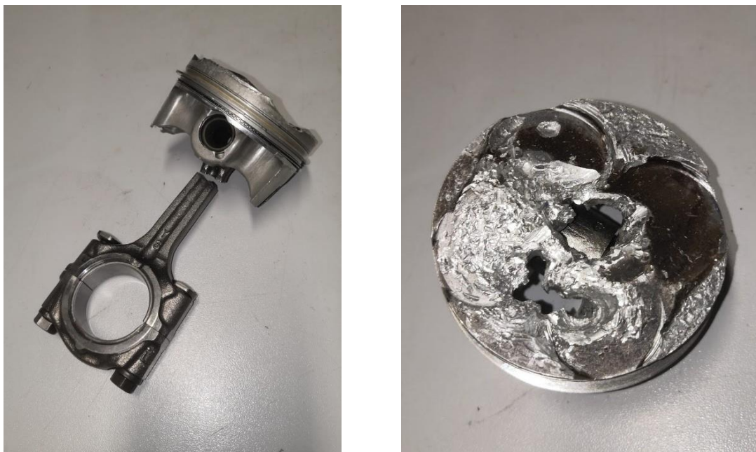
Obrázek 9 – Poškozená ojnice a píst [Vlastní zdroj]
