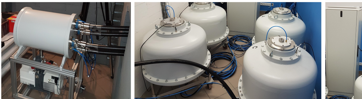
Obrázek 5.2: Zleva: multi-anodová trubice, kondenzátorové zdroje, skříň s řídicí jednotkou
