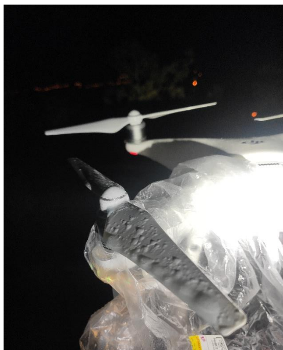
Obrázek 34a Testování protinámrazové kapaliny na vrtulích – před testem
