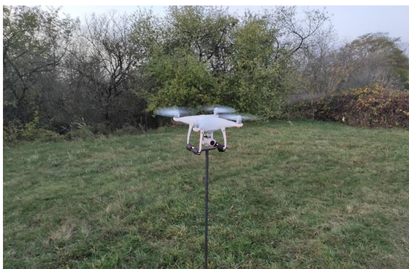
Obrázek 47 Upravený stojan měření
