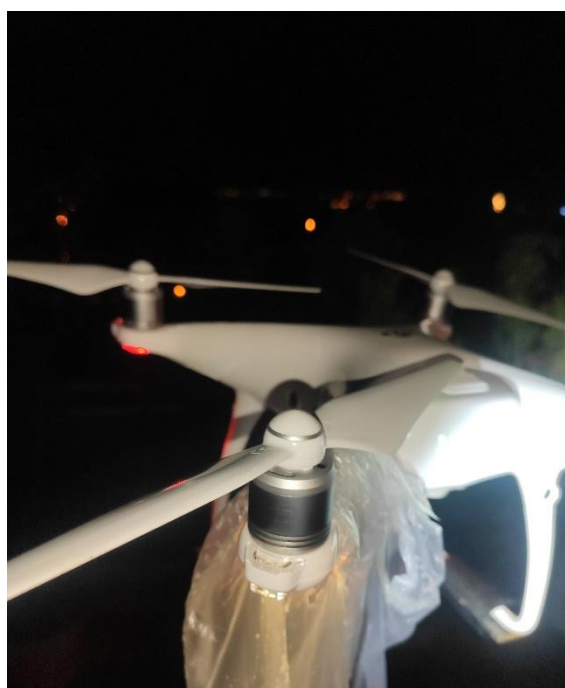
Obrázek 34b Testování protinámrazové kapaliny na vrtulích – po testu
