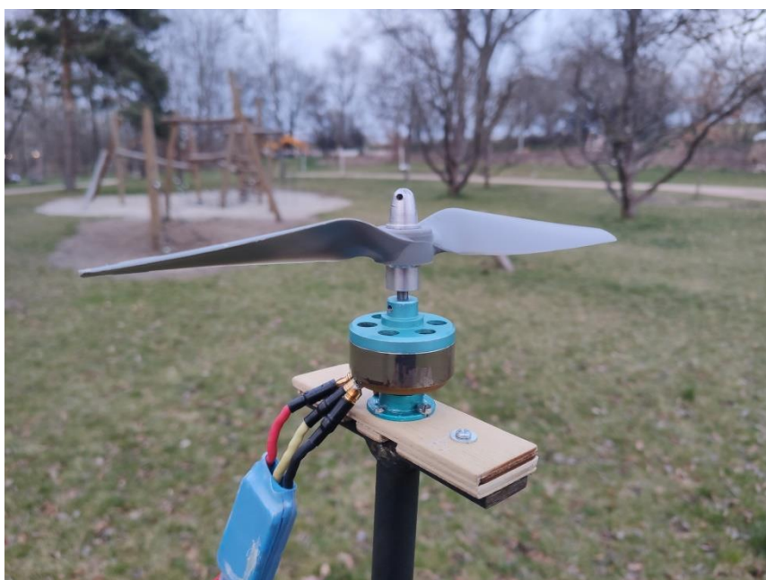
Obrázek 41 Pohonná jednotka umístěna na konzoly [vlastní]
