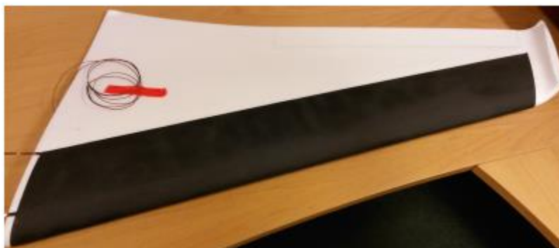
Obrázek 32 Použití nanomateriálu na náběžné hraně křídla [24]
