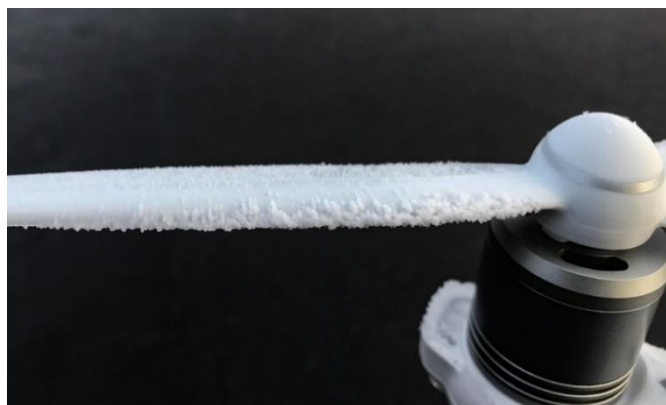
Obrázek 18 Vzniklá námraza na listu multikoptéry
