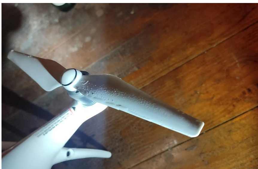
Obrázek 48 Vzniklá námraza na DJI Phantom 4
