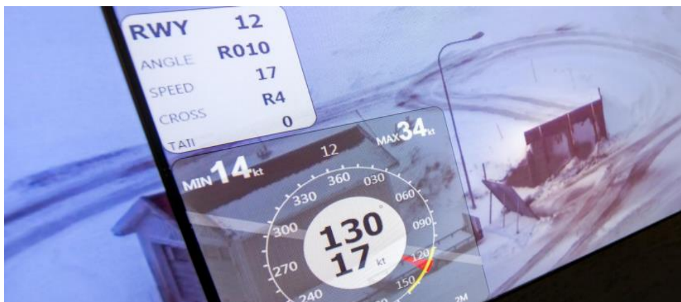
Zobrazení údajů AWOS na displeji v RTM. Zdroj: [41]
