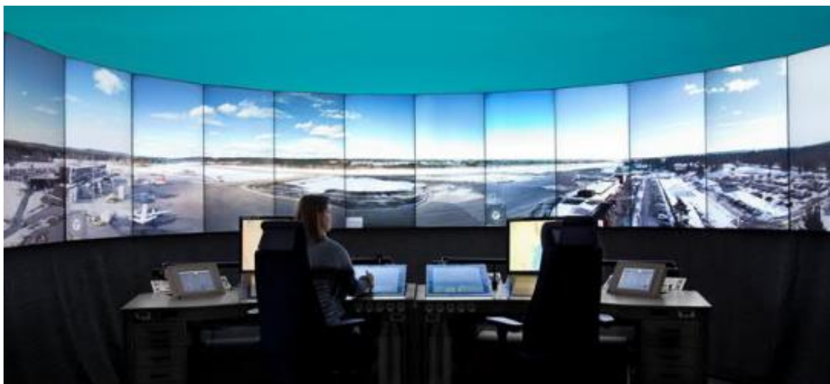
Obrázek 9 Konfigurace RTM ve švédském RTC Sundsvall. Zdroj: [43]
