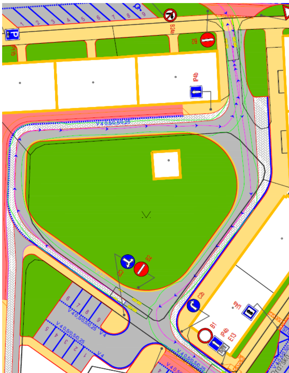
Obrázek 5.38: Obalové křivky hasičského vozu v sídlišti [32].
