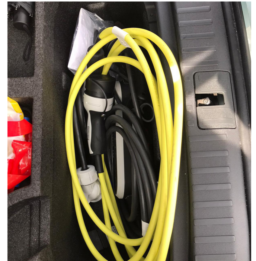
Kabely pro propojení nabíječky a elektromobilu, AC dobíjení
