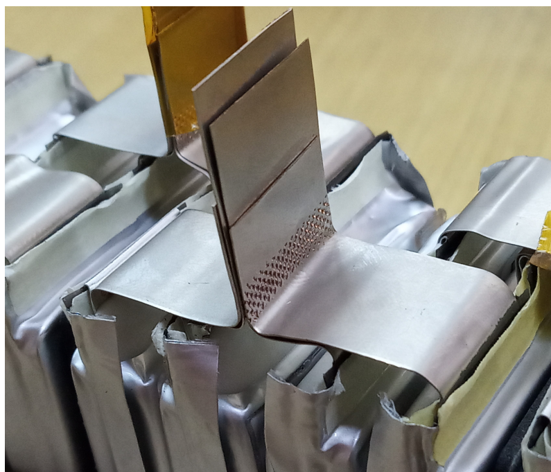
Obrázek 5.6: Detail ultrazvukového sváru čtveřice baterií.
