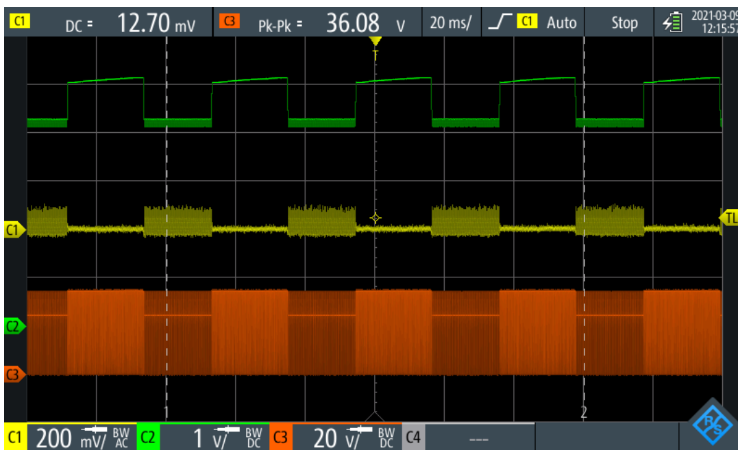
Obrázek 7.3: Průběhy vybraných napětí při testování měniče 1.
