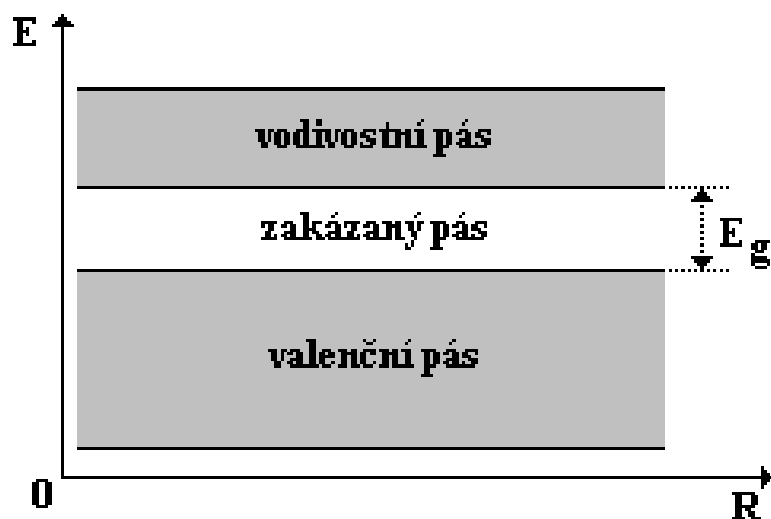
Obrázek 5: Pásová struktura polovodiče bez příměsí [7]
