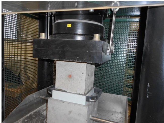
Obr. 29 Pohled na zkoušku drátkobetonové krychle na pevnost v tlaku.
