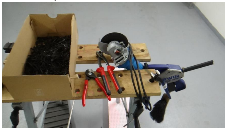
Obr. 11 Vytěžené čisté drátky délky 300 – 500mm, které je nutno nařezat na potřebnou délku 35 – 50mm.
