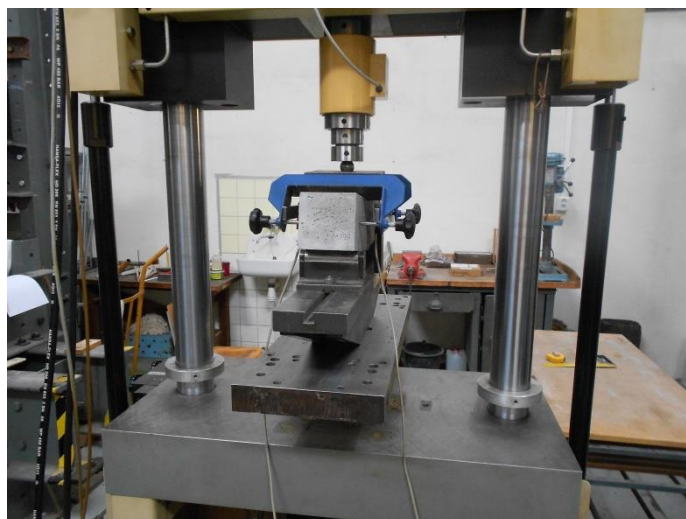
Obr.17 Schéma uspořádání zkoušky tlaku za ohybu.
