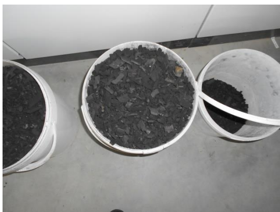
Obr. 8b Vědra s rozpadlou gumovou hmotou různé zrnitosti.
