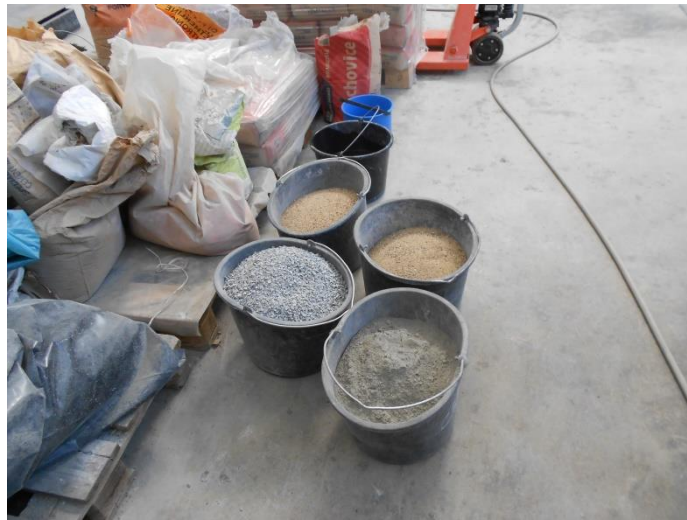
Obr. 23 Příprava přísad nové betonové směsi pro vláknobeton v laboratoři.
