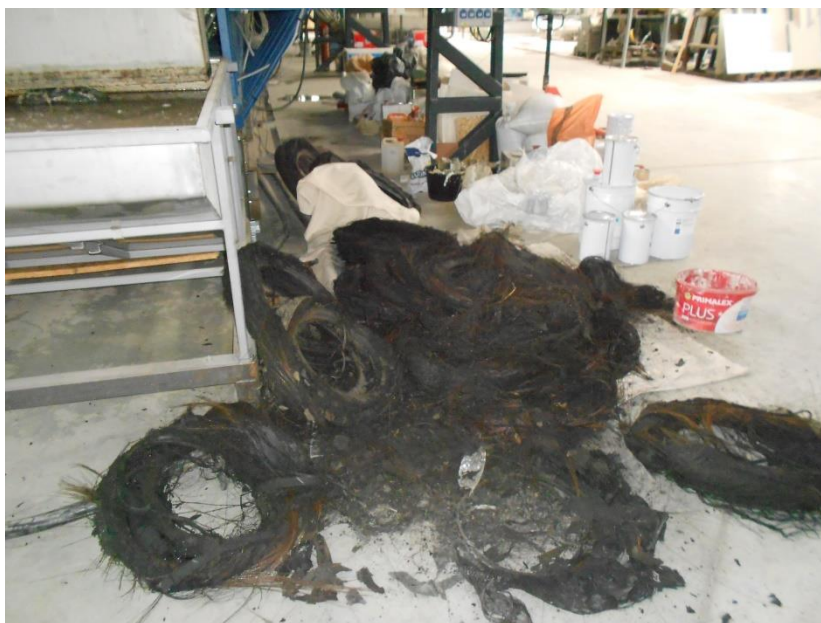
Obr. 15 Výsledný zbytek ocelové kostry pneumatiky, po recyklaci více pneumatik.
