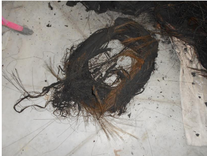
Obr. 10 Zbytek tzv. železa po recyklaci pneumatiky, základní produkt pro druhotnou recyklaci ocelových drátků.
