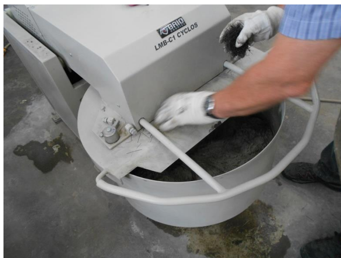
Obr. 25 Postupné vkládání ocelových vláken do míchačky.
