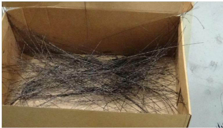
Obr. 10 Zbytek tzv. železa po recyklaci pneumatiky, základní produkt pro druhotnou recyklaci ocelových drátků.
