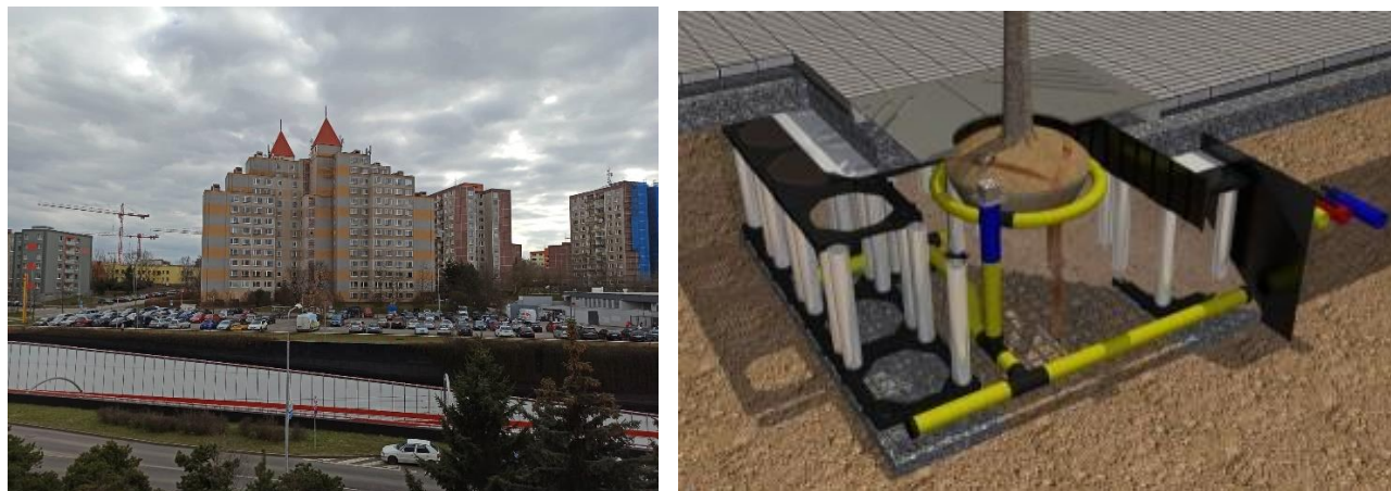
Obr. č. 43 Pohled na parkoviště / Obr. č. 44 Vizualizace provedení prokořenitelné buňky / Zdroj:greenmax.cz
