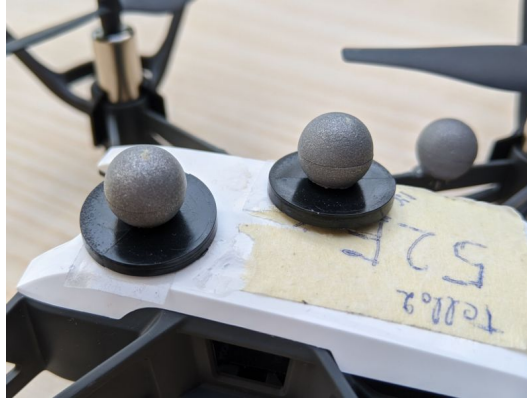
Obrázek 3.6: Umístění markerů (reflexních kuliček) systému Vicon na helikoptéru Tello
