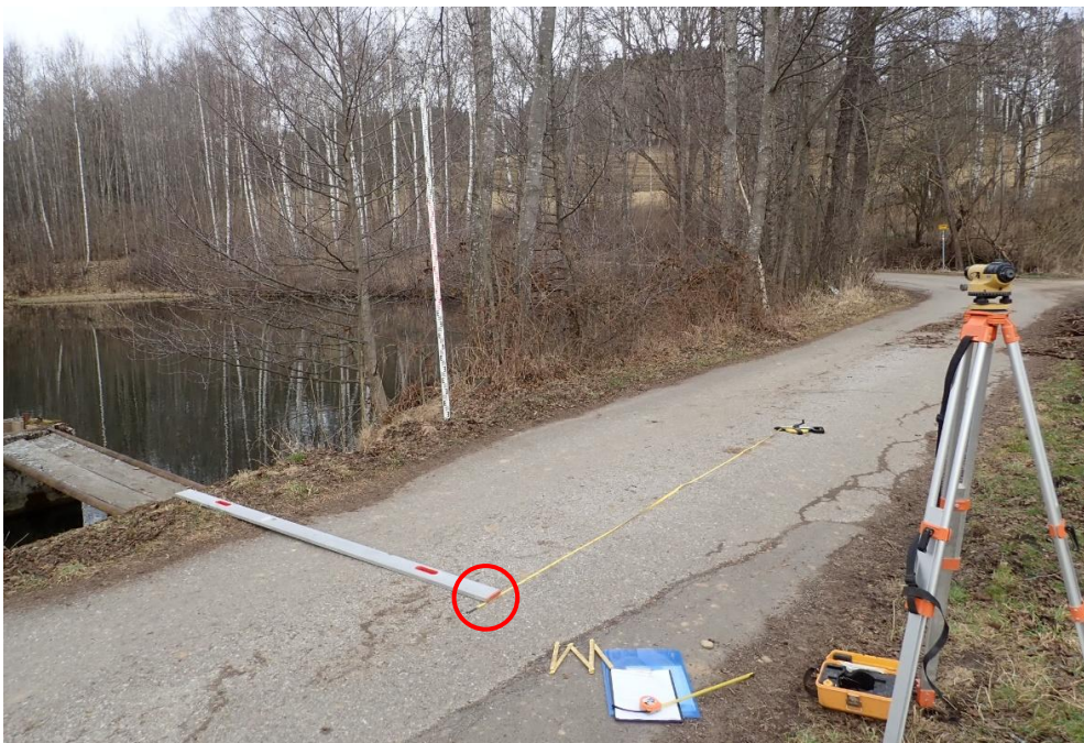
Obrázek 5: Zaměřování výšek na hrázi Bolešského rybníka pomocí nivelace (foto autor)
