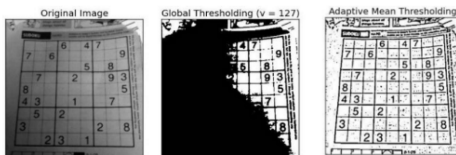
Obrázek 1.12: Adaptivní prahování. Převzato z [12]
